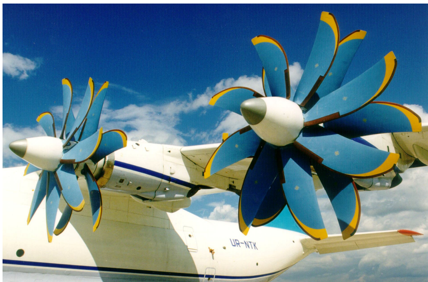
ТВВД Д-27 эксплуатируются на военно-транспортном самолете короткого взлета и посадки Ан-70
