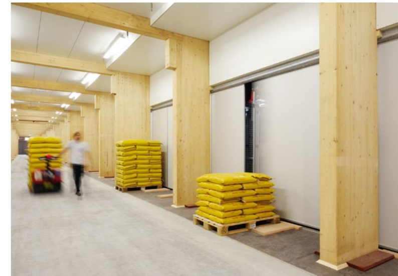
Vier Regalbediengeräte (RBG) liefern von beiden Seiten den Nachschub in die drei geräumigen, hellen Kommissioniertunnel, die sich über die gesamte Länge des Hochregallagers erstrecken. 324 Kommissioniertore von LTW sorgen für die sicherheitstechnisch geforderte Abgrenzung zwischen Tunnel und RBG-Fahrgassen.
