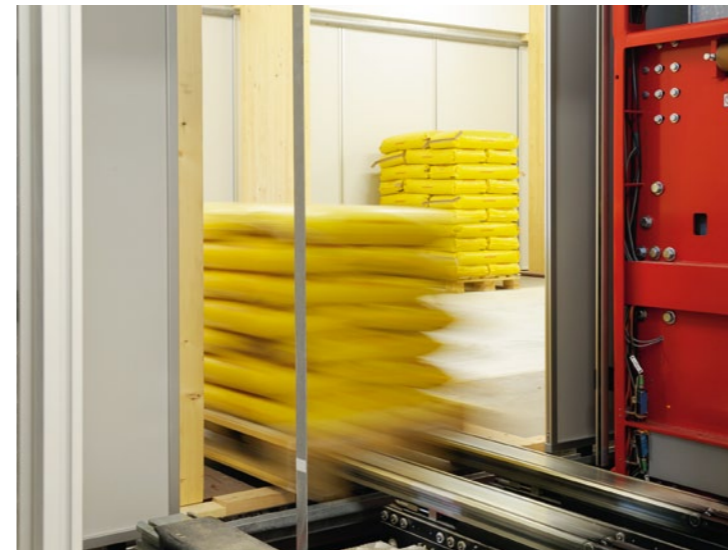
Vier Regalbediengeräte (RBG) liefern von beiden Seiten den Nachschub in die drei geräumigen, hellen Kommissioniertunnel, die sich über die gesamte Länge des Hochregallagers erstrecken. 324 Kommissioniertore von LTW sorgen für die sicherheitstechnisch geforderte Abgrenzung zwischen Tunnel und RBG-Fahrgassen.
