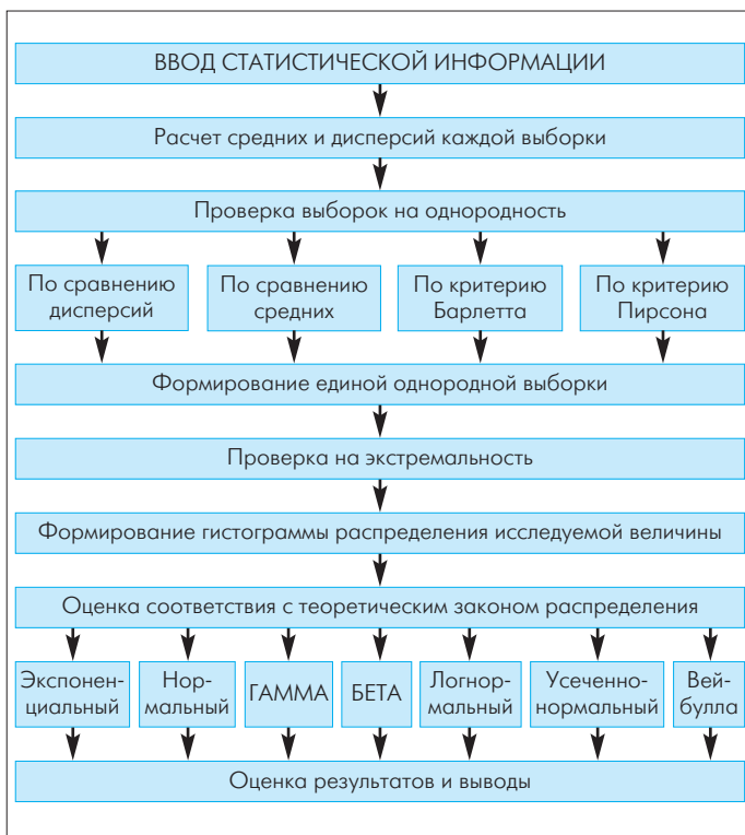
Рис.3. Алгоритм обработки данных для оценки состояния РЭС
