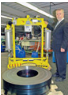
Schwere Coils können mit den Vakuumhebeanlagen, die hier Firmenchef Herbert Timmer präsentiert, mühelos angehoben werden.
