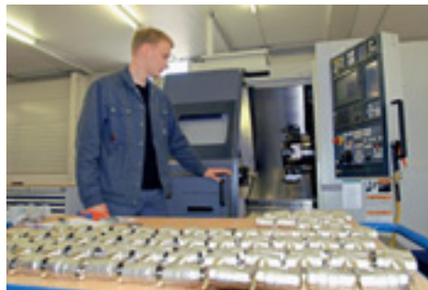
Mit Fräsmaschinen werden im eigenen Haus die Prototypen erstellt oder auch Kleinserien auf spezielle Kundenwünsche angepasst. Andreas Kiewe lässt hier zum Beispiel Gewinde auf Kugelhahne fräsen, damit diese in Schaltschränke eingebaut werden können.
