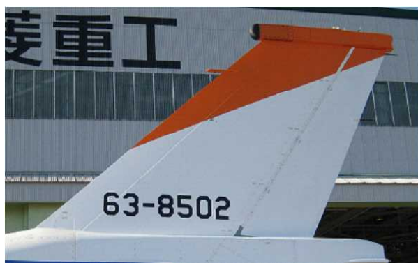
垂直尾翼に搭載された高精度方探アンテナ
