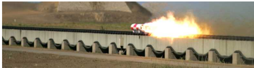
レールランチャーによるスレッド試験
