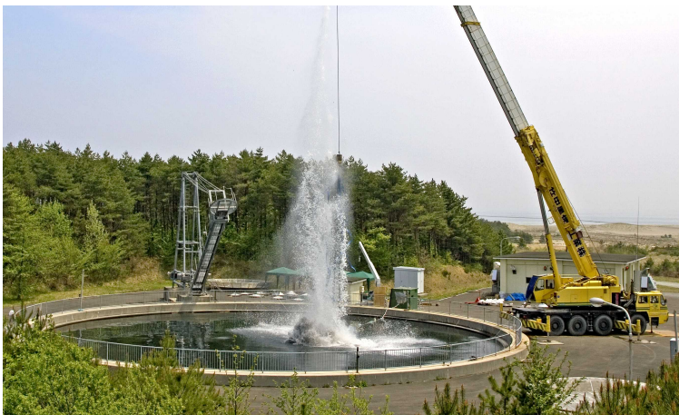
水井戸槽による水中爆破試験 (艦艇構造材料耐衝撃試験)
