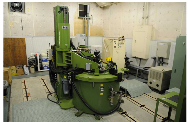
小型高速繰り返し回転試験装置
