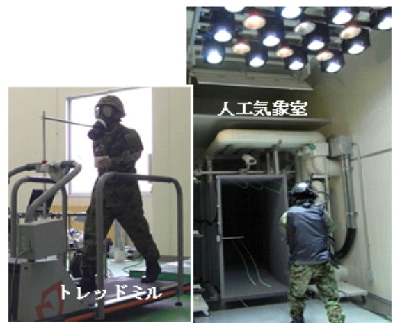
個人防護装備品試験評価装置（目黒地区）
