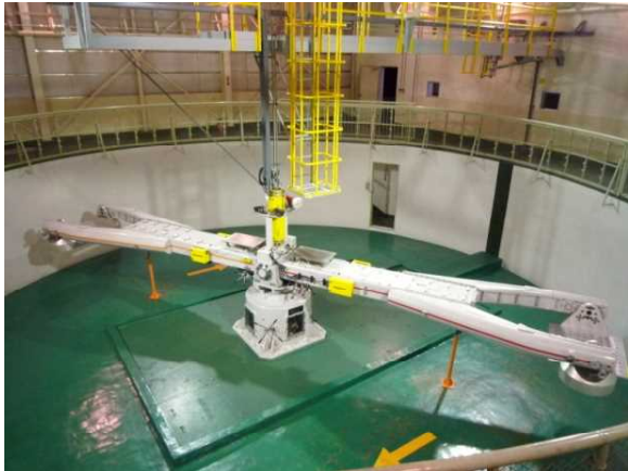
遠心加速度試験装置
