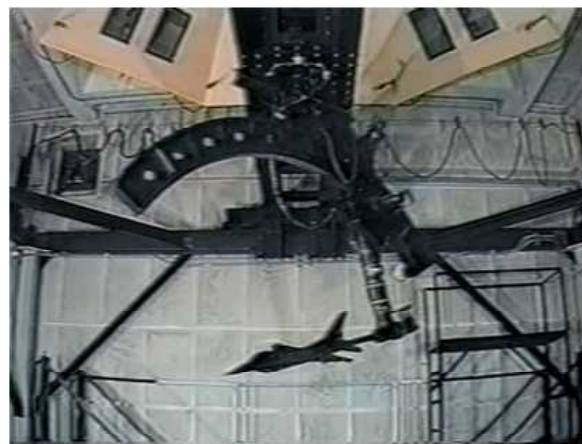
回転式荷重測定装置
