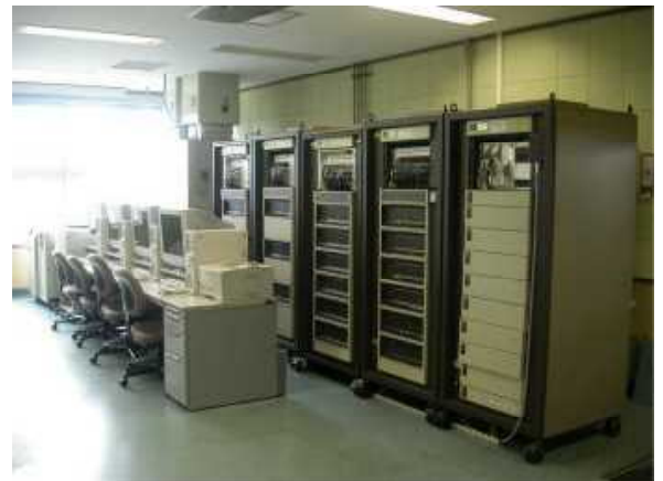
次期固定翼哨戒機用全機静強度試験装置
