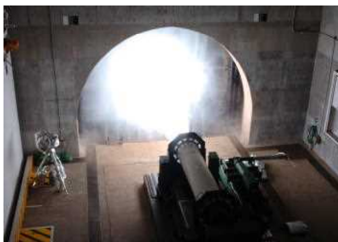
弾道ミサイル防衛用誘導弾構成要素の燃焼試験
