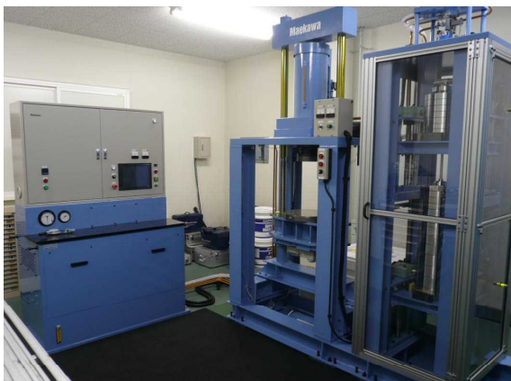
推力荷重校正装置（平成23年度更新）
