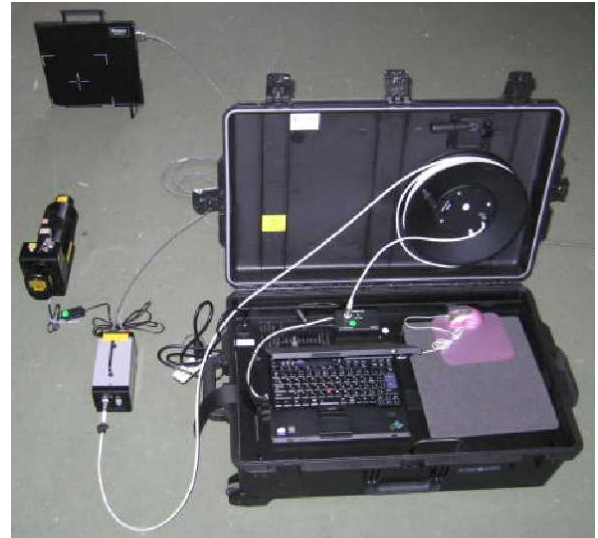
弾頭・信管識別装置 (信管・弾丸等内部構造等の調査)
