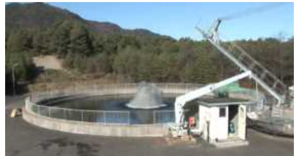
水井戸槽による水中爆破試験 (弾頭生成破片調査)
