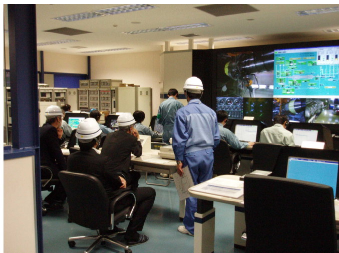
F3エンジンのJP-8適合性確認試験
