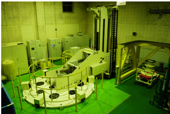
大型スピン試験装置
