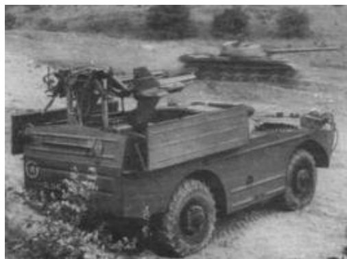
În stânga, prima instalație de lansare rachete antitanc folosită în România, 2 P 26. Aceasta lansa 4 rachete 3 M 6 și a fost urmată de o instalație mai modernă 2 P 27 (BRDM 1)-dreapta.
