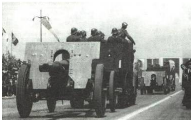
Secție de tunuri lungi de câmp tip „Schneider”, cal. 105 mm, md. 1936 dintr-un regiment de artilerie grea motorizată, la parada anuală din 10 mai 1942. Piesele erau remorcate de autotractoare „Skoda” tip 6 STP 6L.
