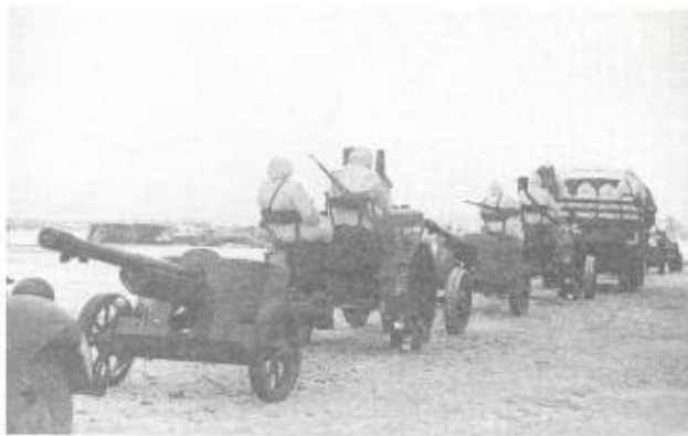
20 decembrie 1943. Coloană de tunuri Pak 97/38 cal. 75 mm din Centrul de Instrucție Antitanc de la Mihai Bravu, remorcate cu tractoare agricole „Lanz Bulldog” D 8.500
