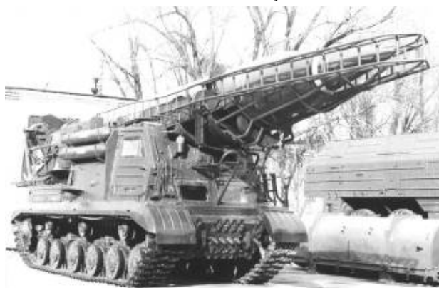
Racheta 8 K 11 pe instalația de lansare 8 U 218
