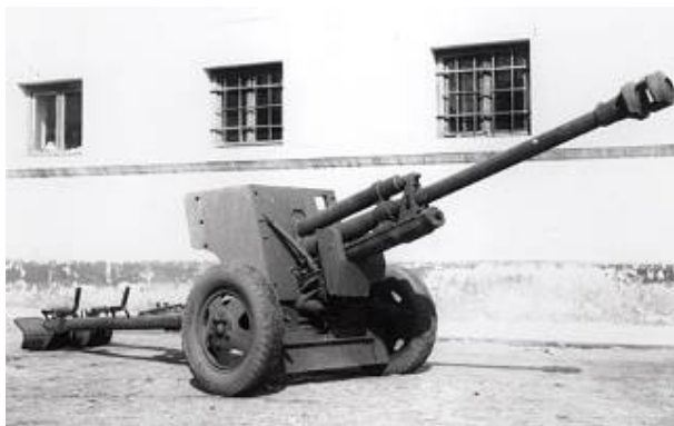
Tunul antitanc DT-UDR 26 (Resita), calibrul 75 mm, model 1943, o realizare de excepție a industriei naționale.
