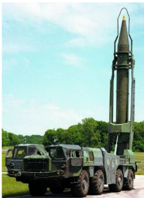
Instalația de lansare 9 P 117 M1 cu racheta 8 K 14 în poziție verticală. Înaintea lansării era necesar ca “săgeata” instalației de lansare să fie coborâtă (dispozitivul hidraulic care așa cum se vede în fofografie ridică racheta sau o cobora în cazul în care lansarea era anulată).
