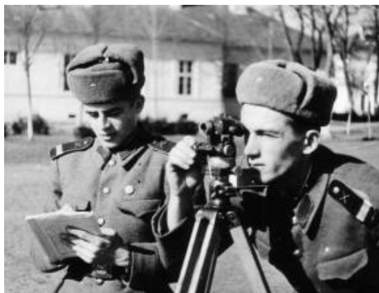
Eleii din școala de ofițeri executând măsurători cu goniometrul busolă. Sibiu, 1964
