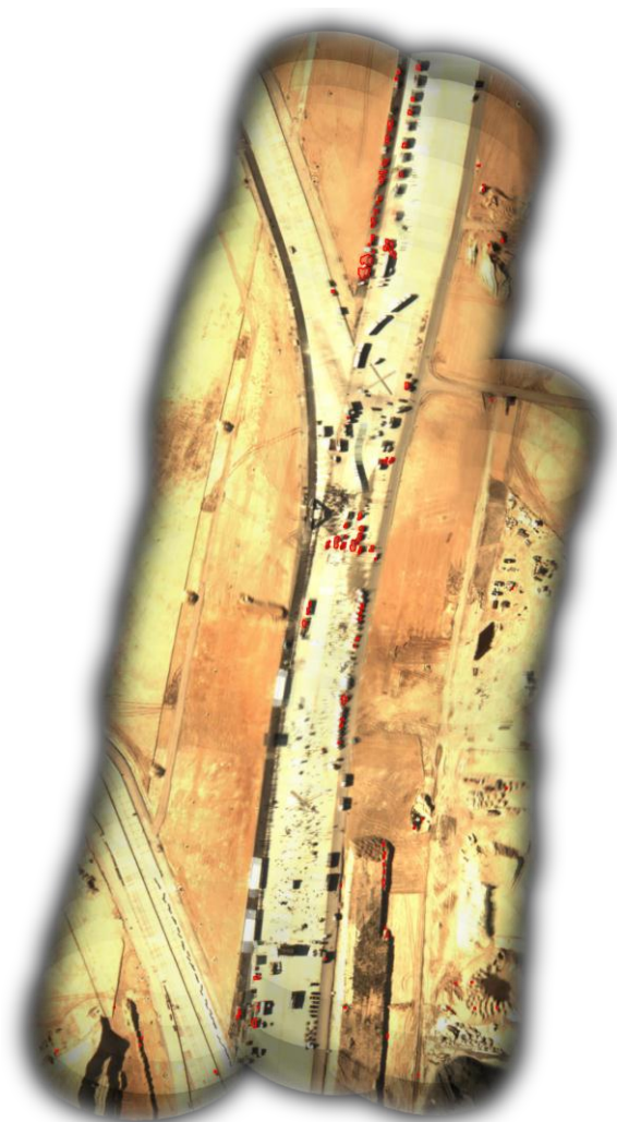
Abbildung 2: Kartendarstellung mit erkannten Objekten (rot markiert), zusammengesetzt aus einer Videosequenz von etwa 100 Luftaufnahmen
