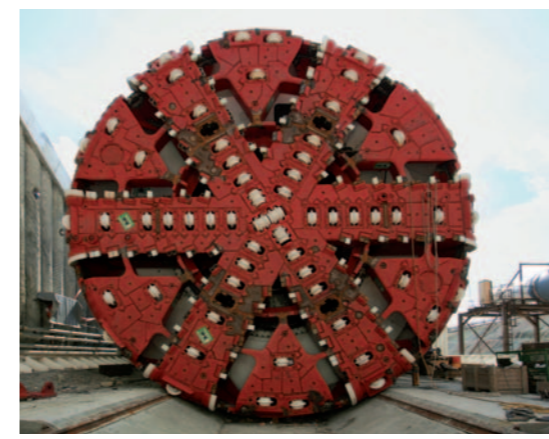
Schneidrad einer Tunnelvortriebsmaschine
