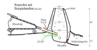
Als Folge von silikatischen Beimengungen im Erz und der Reaktion mit der Ofenwand, entsteht eine eisenreiche Schlacke, die ab ca. 1.200°C verflüssigt, und im untersten Bereich des Ofens
