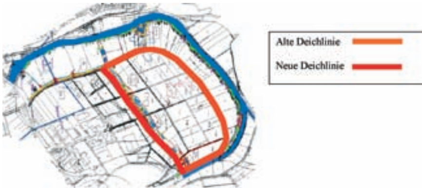
Abbildung 23: Deichrückverlegung in Marburg Stadtteil Wehrda
