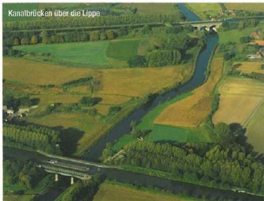
Im Verlauf der Kanaltrassen werden viele Landverkehrswege und Gewässer gekreuzt. Besonders interessant sind die Kanalbrücken im Zuge der langen Dammstrecken, durch die die Schifffahrt ohne Höhenverlust größere Flusstäler überqueren kann.
