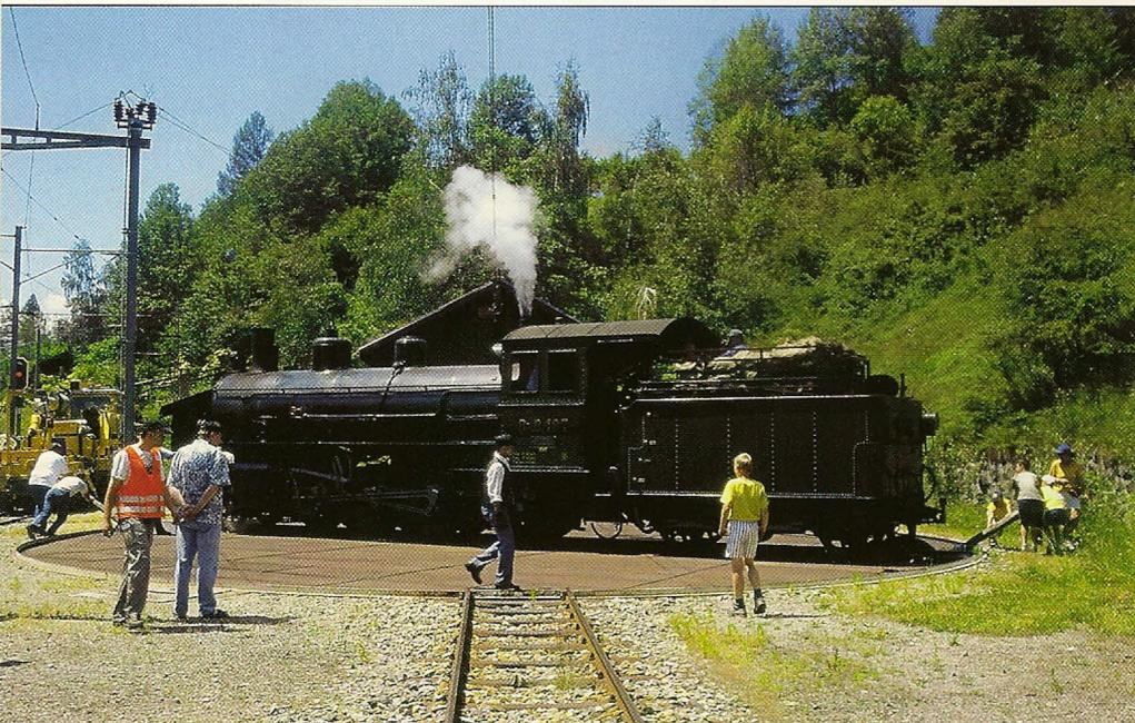
*Drehscheibe mit Dampflok beim Abdrehen in Filisur*
