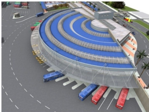
El mayor perímetro del semicírculo ofrece más capacidad de plataforma favoreciendo la operación de los buses y taxis.
