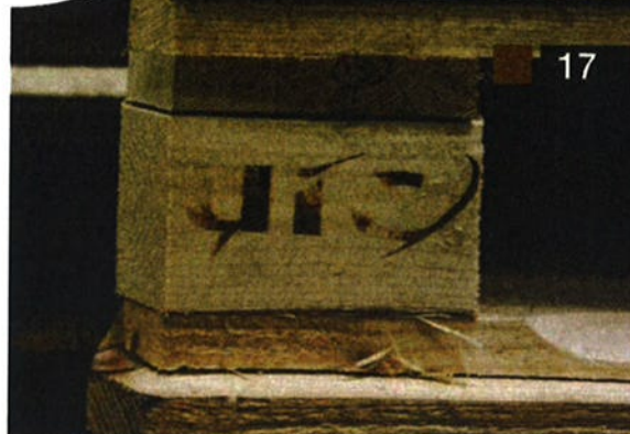
Deze pallet met UIC-brandmerk is uitwisselbaar met de europallet van Epal.
