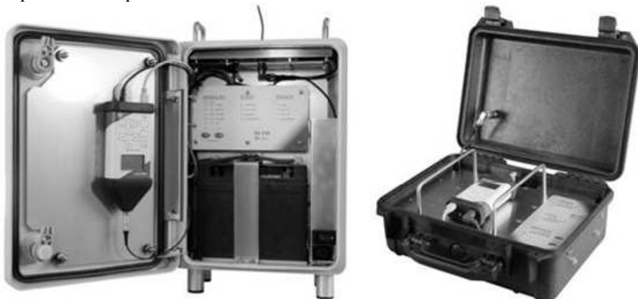
Рисунок 1. Станции мониторинга шума фирмы "СВАНТЕК". Станция длительного мониторинга - слева, периодического - справа
