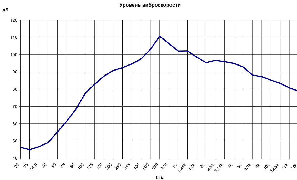
Рис. 2.2. Уровни виброскорости на подошве рельса при прохождении электропоезда на скорости 65 км/час
