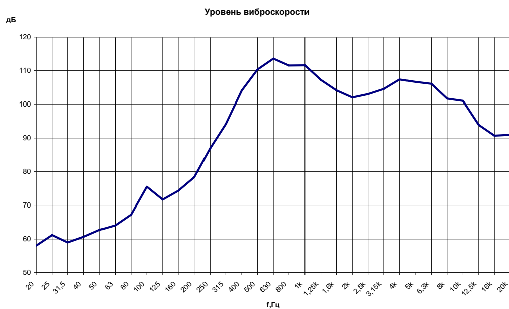
Рис. 2.8. Уровни виброскорости на подошве рельса при прохождении пассажирского поезда на скорости 74 км/час
