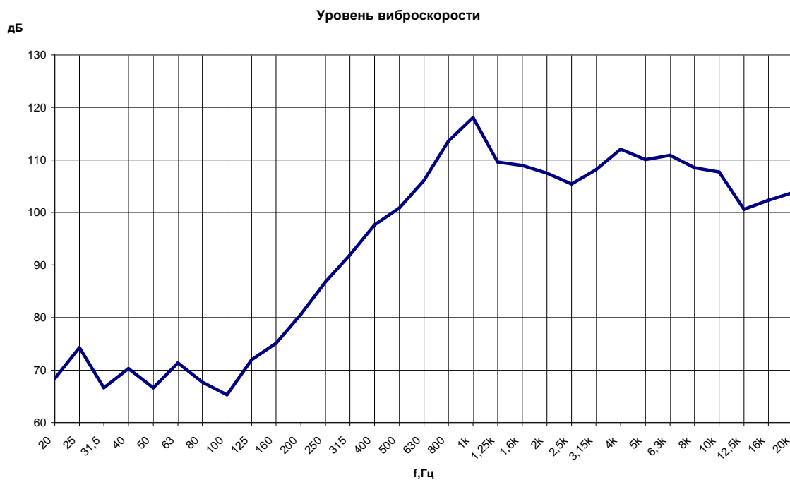
Рис. 2.16. Уровни виброскорости на подошве рельса при прохождении скорого поезда на скорости 107 км/час
