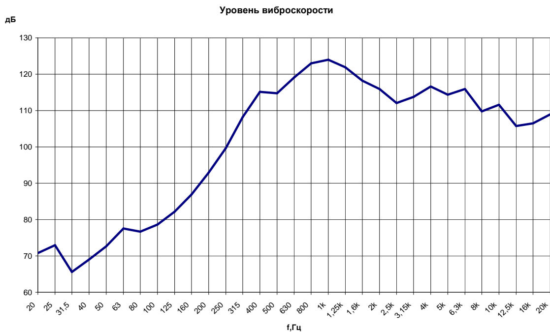
Рис. 2.4. Уровни виброскорости на подошве рельса при прохождении электропоезда на скорости 113 км/час
