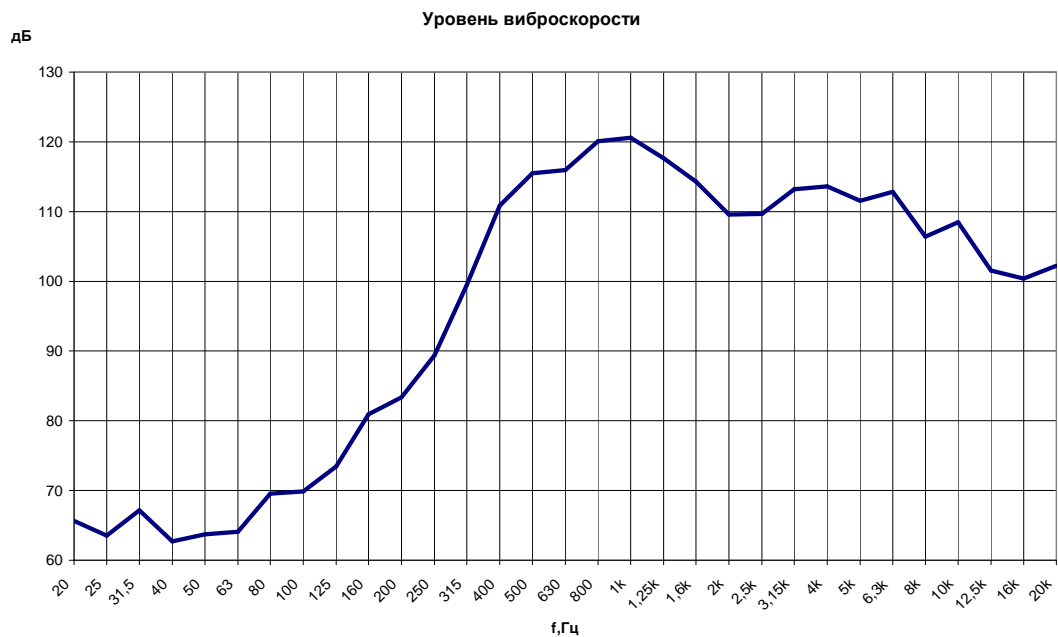
Рис. 2.10. Уровни виброскорости на подошве рельса при прохождении пассажирского поезда на скорости 92 км/час
