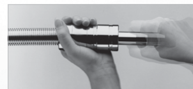
4. Klemmbacken schließen. Durch Bewegen des Schlagbolzens die Welle zu einem Bördel anstauchen.
