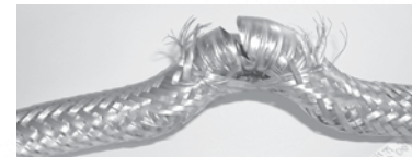
Bild 4.1.2 Geflechtsversagen und anschließender Schlauchbruch
