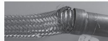
Bild 4.1.3 Geflechtsversagen an der Einbindung
