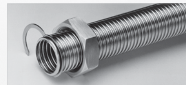
6. Klemmring in das erste Wellental einlegen und zu einem geschlossenen Ring zusammendrücken. Dichtung einlegen, Einschraubteil aufsetzen und mit zwei Sechskantschlüsseln anziehen.
