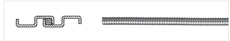
Bild 2.6.5 Wickelschlauch mit Dichtfaden
