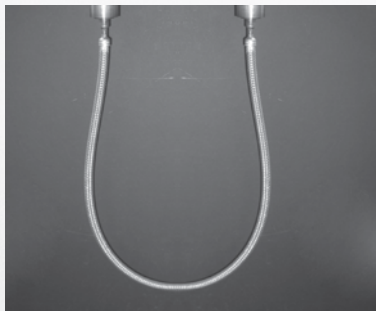
Bild 4.1.6 Biegelinie im U-Bogenversuch unter Innendruck.
