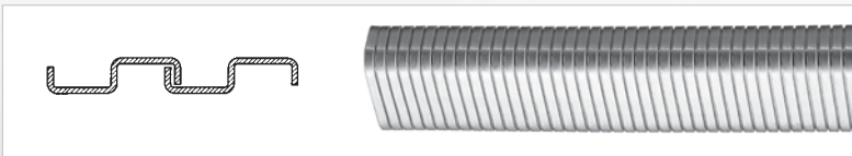
Bild 2.6.3 rechteckiger Wickelschlauch mit Hakenprofil
