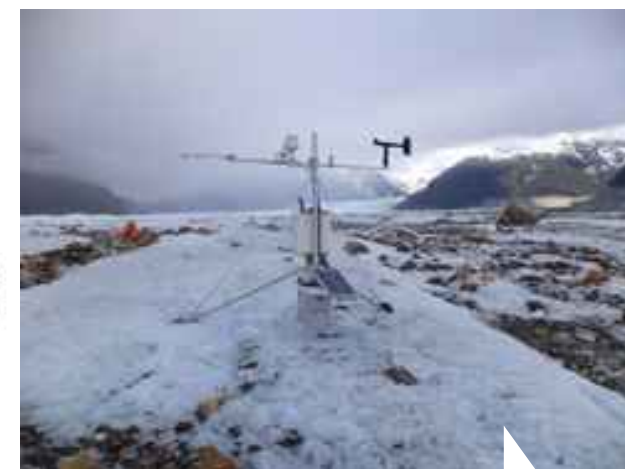
Estación meteorológica automática ubicada en la zona de ablación del glaciar Exploradores, Campo de Hielo Norte. Noviembre, 2013.
