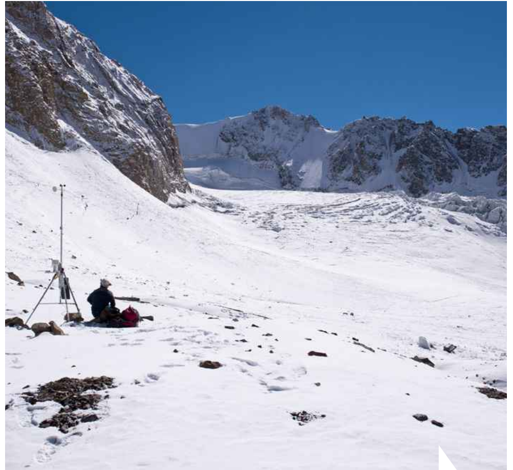
ESTACIÓN METEOROLÓGICA AUTOMÁTICA EN EL GLACIAR YESO. CUENCA DEL RÍO MAIPO, REGIÓN METROPOLITANA. ABRIL, 2013.
