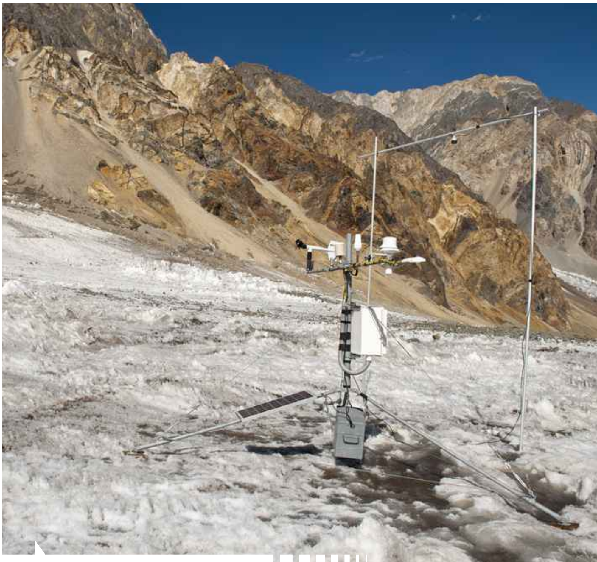
GLACIAR BELLO ESTACIÓN METEOROLÓGICA PORTÁTIL Y MARCO DE ABLACIÓN EN LA SUPERFICIE DEL GLACIAR BELLO. CUENCA DEL RÍO MAIPO, REGIÓN METROPOLITANA. FEBRERO, 2014.
