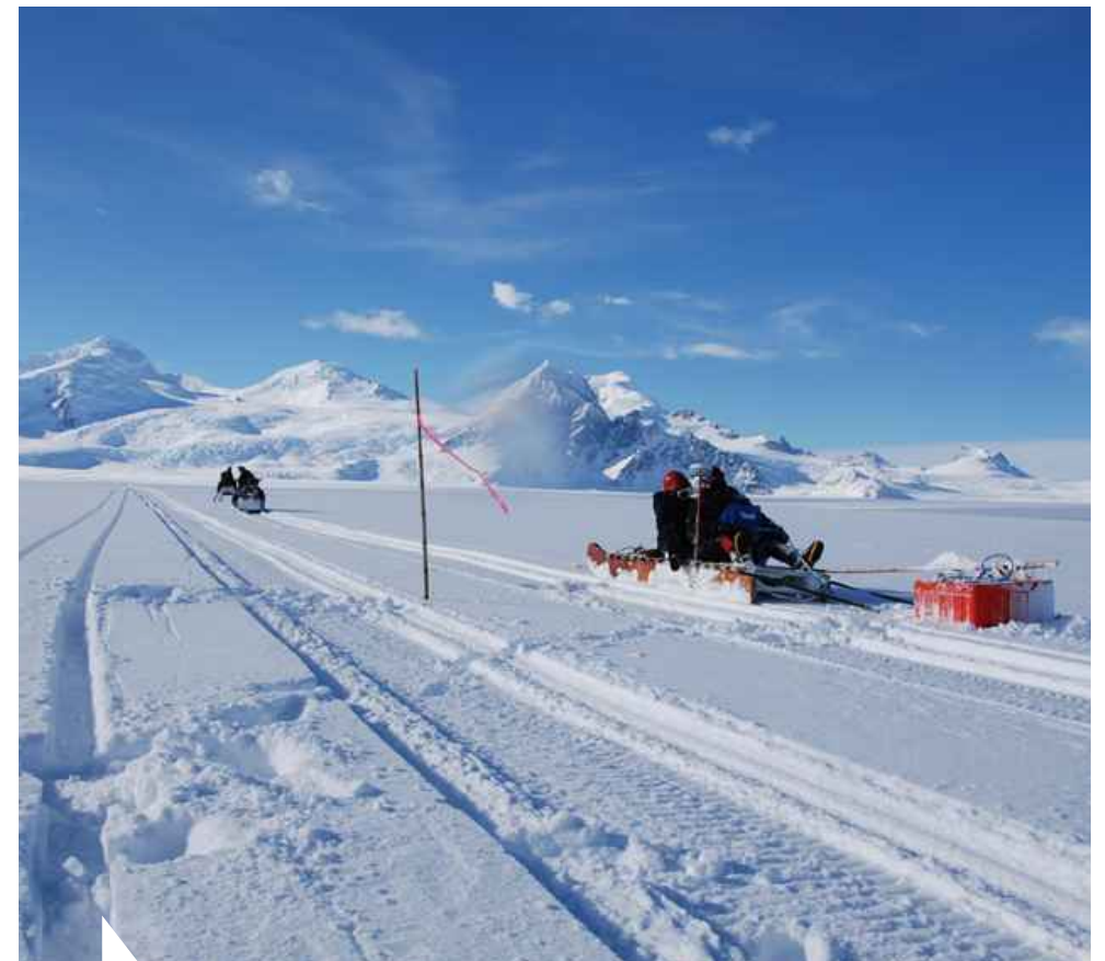
GROUND PENETRATING RADAR (GPR) PARA DETERMINAR EL ESPESOR DEL MANTO INVERNAL EN LA MESETA DEL GLACIAR SAN RAFAEL. AGOSTO, 2011.
