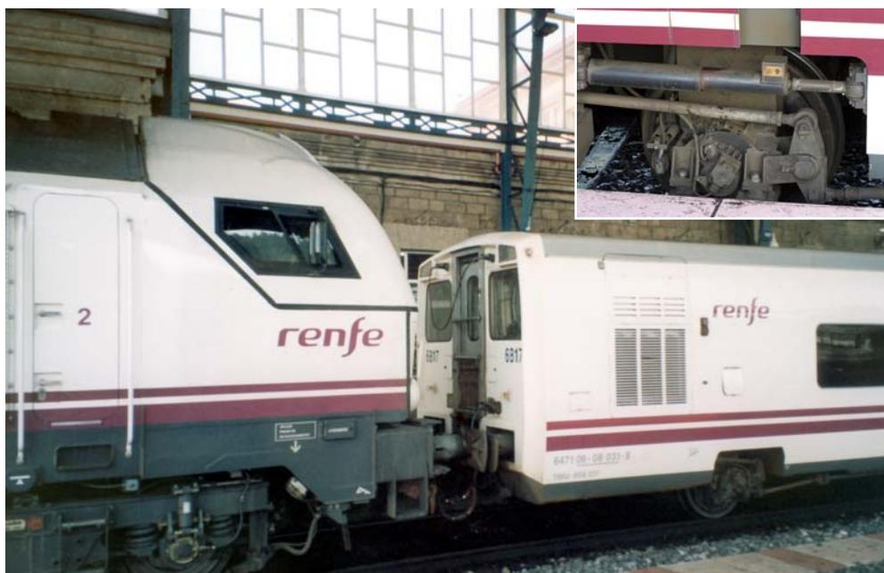
Un treno costituito da carrozze pendolanti Talgo trainate da ordinario locomotore diesel, non pendolante. Rispetto ad un convoglio con carrozze non pendolanti, non ci sono differenze nell'accoppiamento locomotore-carrozza di testa. Quest'ultima però dispone di un assale ausiliario (visibile sotto la scritta "renfe") in aggiunta a quello ordinario in comune con la carrozza successiva, mostrato nel riquadro.
