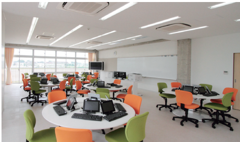
コンピュータ教室。端末はシンクライアント方式で整備され、グループ学習ができる机配置。ディスプレイ部をキーボードから取外して使うこともできる
