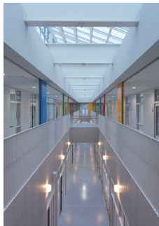
管理・特別教室棟3階廊下。2階吹抜けの建物中央から採光することで明るい校舎を実現
