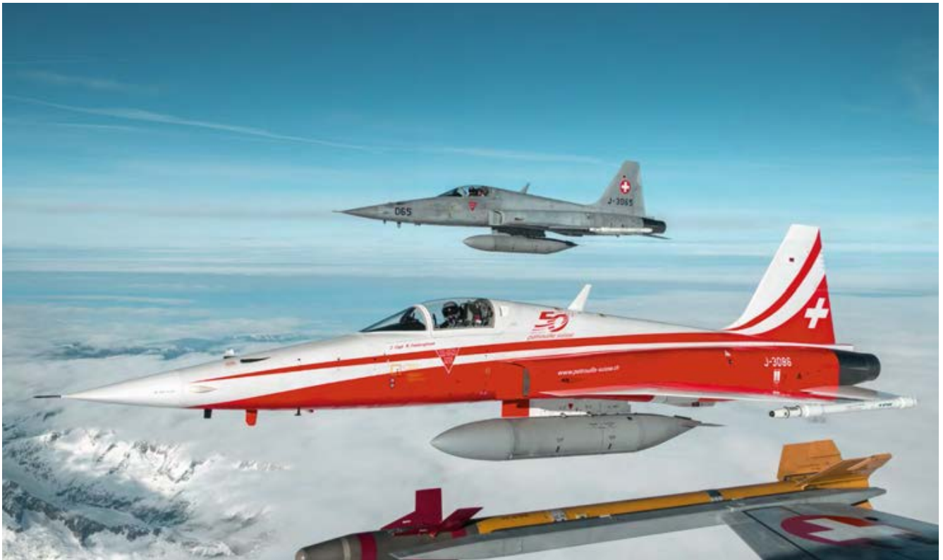
Bei der Schweizer Luftwaffe sind die Flugzeuge nicht fix den Staffeln zugeteilt, so kommen bei der Staffel 6 auch Tiger in Patrouille-Suisse-Bemalung zum Einsatz. An den linken Flügelenden tragen die Tiger Flight Profile Recorder (FPR), welche die relevanten Leistungsparameter aufzeichnen und eine 3D-Rekonstruktion des Fluges für das Debriefing erlauben.
