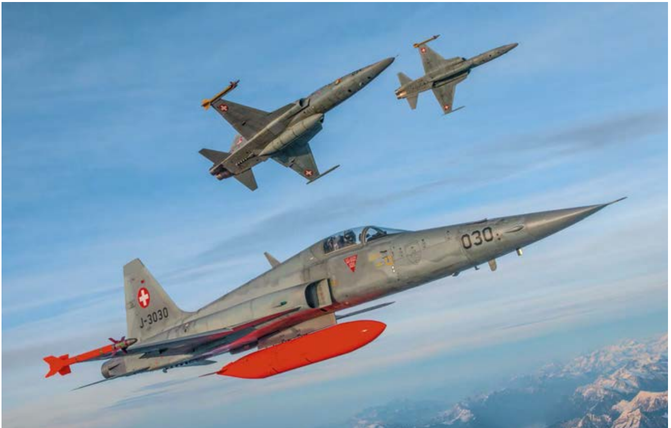
Die zwei General Electric J85-GE-21A Triebwerke ermöglichen dem F-5E Tiger eine Anfangssteiggeschwindigkeit von 174 Metern pro Sekunde.
