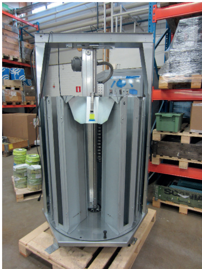
KUVA 1. Esimerkkejä Mikemetin kokoonpanotuotteista on älykäs käsineautomaatti, joka huolehtii työkalujen jakelusta. Tunnistuksen perusteella saa oikean kokoiset ja omat käsineesi. Kuvassa myös näkyvä automaatin sisälle.
