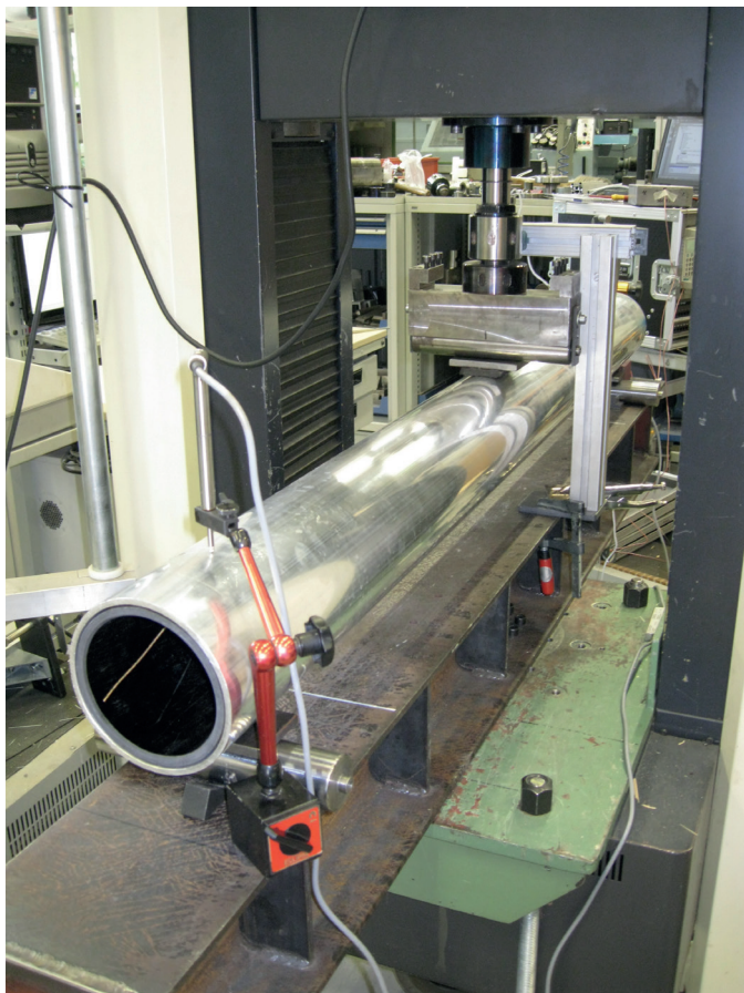
KUVA 1. Alumiini-hiilikuitu -akseli liimaliitoksin valmistettuna.
