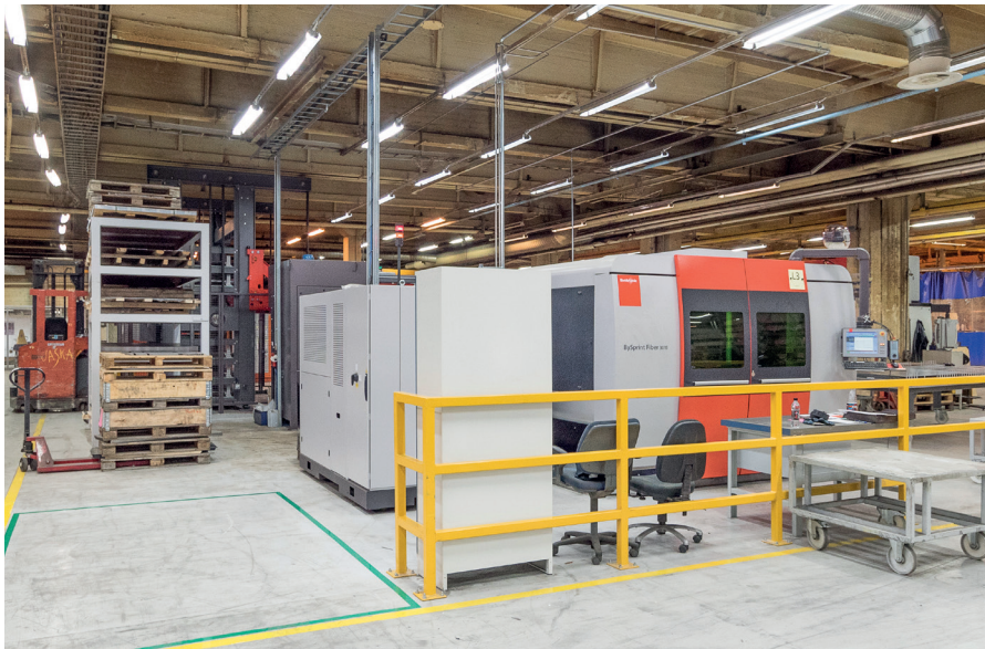
KUVA 1. 6kW Kuitulaser automaattisella lastauksella, purulla ja varastolla.
