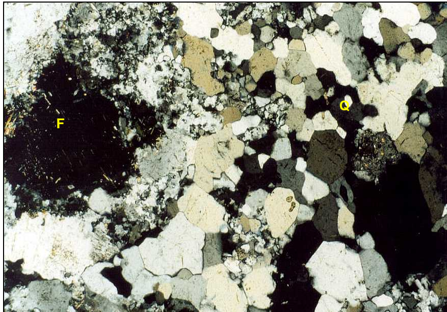
Figura 6.7: Granito gnáissico ao microscópio óptico de luz transmitida, onde se observam grãos de feldspato (F) e de quartzo (Q) com contornos tendendo a retilíneos. Aumento 50x (ABCP, 2007).
