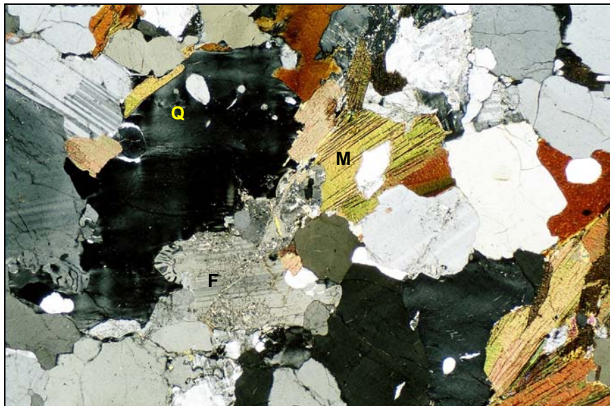
Figura 6.5: Aspecto de detalhe da textura da rocha na qual se observam quartzo (Q), feldspato (F) e mica (M). Aumento 100x (ABCP, 2007).
