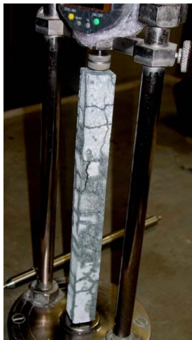
Figura 5.5: Procedimento de leitura da expansão da barra de argamassa (ABCP, 2008)
