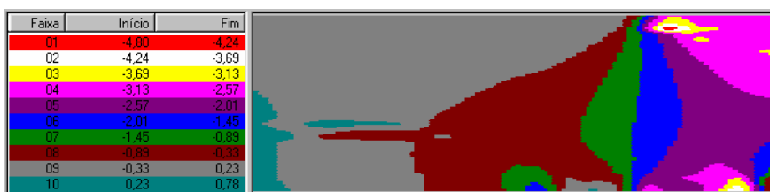
Figura VII.6.18 – Tensões na direção “y” imediatas ao carregamento referente ao bloco 2
