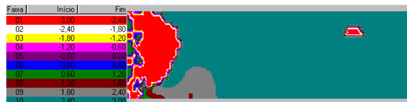
Figura VII.4.19 - Índice de segurança para fluência e RAA aos 2500 dias na direção “y” para o caso “I”
