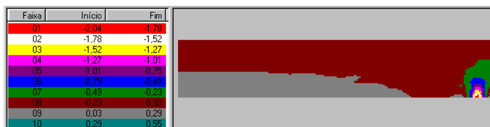
Figura VII.3.19 – Tensões na direção “y” por RAA aos 10000 dias
