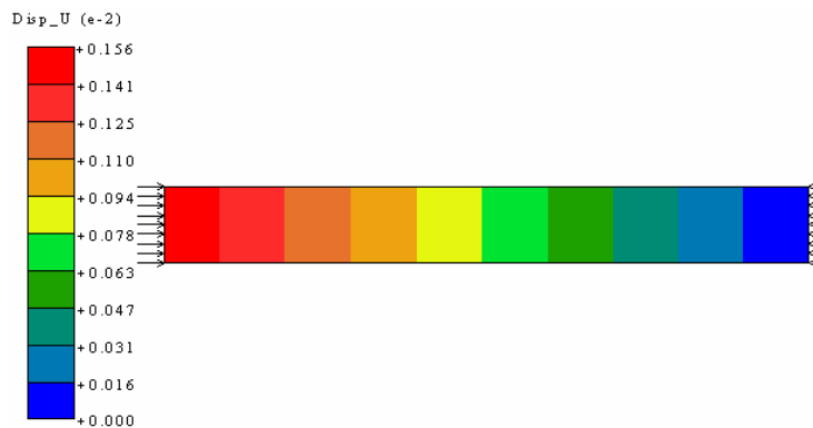
Figura VII.2.16 - Deslocamentos na direção “x” aos 10000 dias por fluência com RAA
