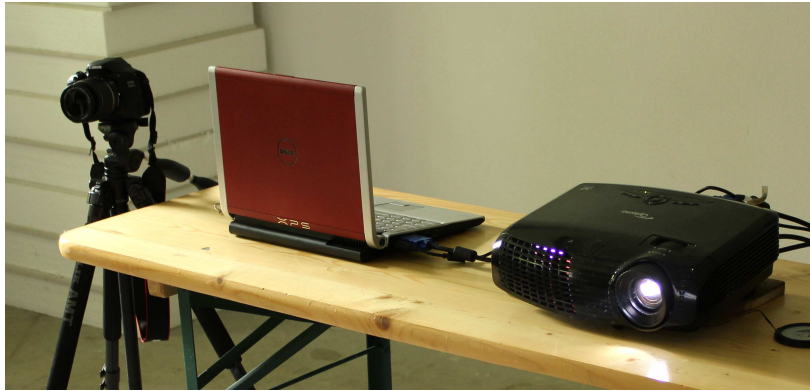
Abbildung 5.1: Das Testsetup besteht aus einer Canon EOS 550D Spiegelreflexkamera und einem Optoma EX542 DLP-Projektor.
