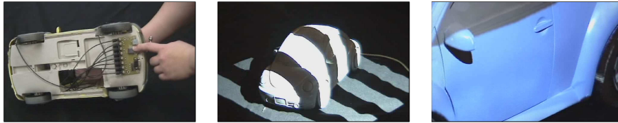
Abbildung 4.4: Automatische Projektor-Kalibrierung mit Hilfe von Lichtsensoren. Durch Streifenlichtprojektion werden die Sensorpositionen ermittelt. Diese Information wird dann zur Korrektur der Projektion herangezogen, um diese genau an die physischen Eigenschaften der Objektoberfläche anzupassen. (Bildquelle: http://johnnylee.net/academic/projcal.mov )
