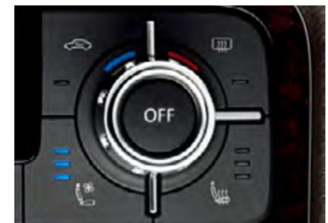
前排座椅的空调功能可以直接对座垫、靠背的通风进行三级独立调节。
