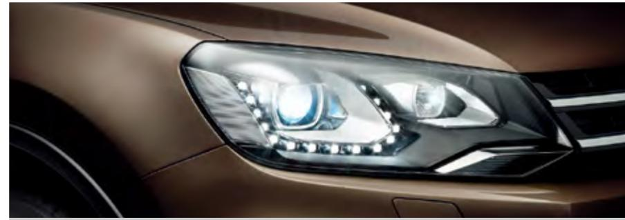
带有动态及静态随动转向双氙气大灯，可随着行驶方向投射近光或远光，有效改善曲线行驶或转弯时道路内侧的照明不足。车速较快时，近光灯光柱会变得更加细长。创新的LED日间行车灯，在日间光照不足时可提供良好照明，同时令新途锐的外观愈显跳脱动感。
