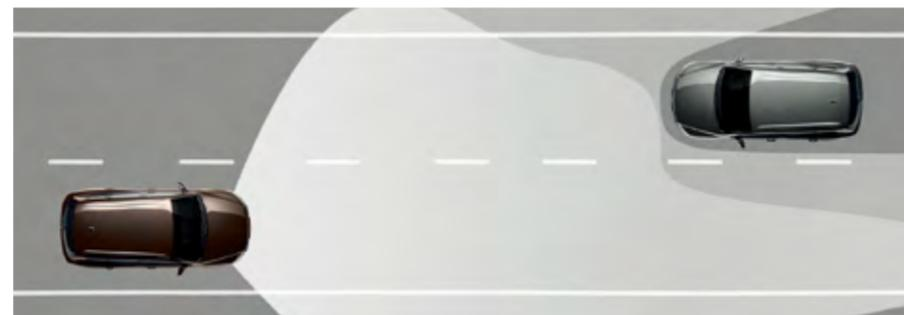
应用于氙灯的动态车灯辅助系统“Dynamic Light Assist”，在远光灯开启后，可自行捕捉对面车辆的光线，对可能造成其他驾驶员眩晕的区域，逐渐减弱光线强度。
