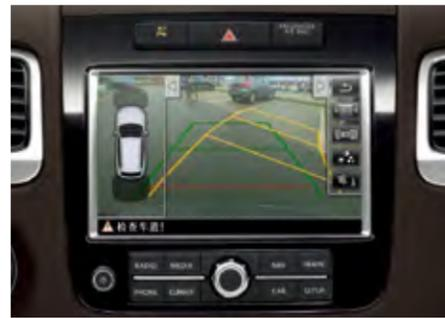
倒车影像“Rear View Camera”可直接将车后方环境图像清晰、真实的呈现至导航系统上，并显示可行驶轨迹，让泊车变得易如反掌。
