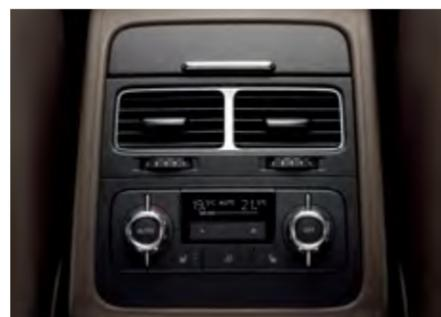
根据车型配备的4区“Climatronic”恒温空调, 可通过自动调节模式, 为您量身设定舒适温度, 后排乘客还可随心调节。当发动机关闭后, 驾驶舱内的加热可通过发动机的余热来进行转换。
