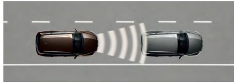
可选装的自适应巡航控制系统ACC，在您与前、后车辆距离过近，速度过快时会及时提示，减慢车速，同时安全带自动收紧，确保所有乘员安全。
