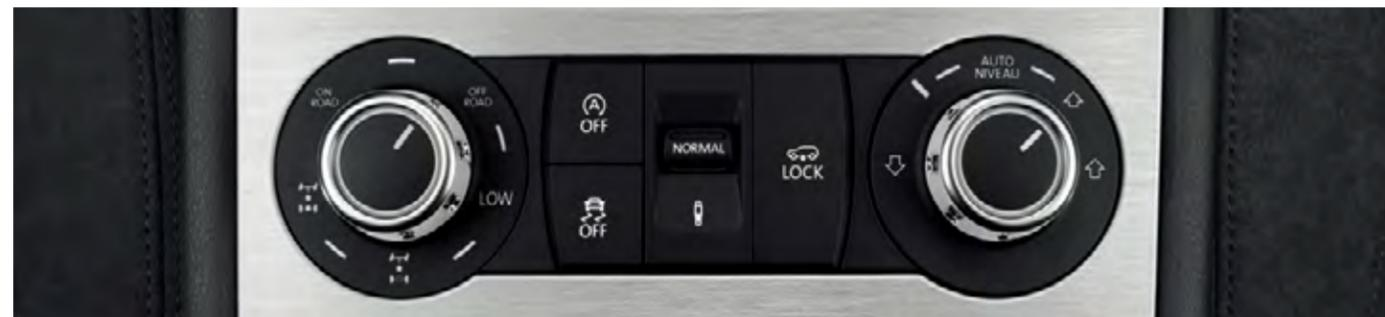
可选装的“Terrain Tech”越野包配有的4XMOTION全时四轮驱动系统，凭借中央差速器及差速锁，通过5档旋转调节开关，可依路况及时调整各车轮的动力分配，即使遭遇恶劣天气，也能保障强大的牵引力、抓地力及攀爬能力，使各项越野性能系数达至峰值。让您从容纵横，享受征服的乐趣。
