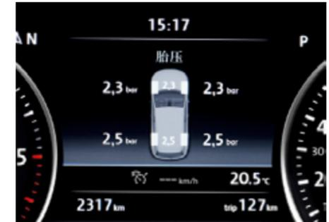
胎压检测系统在多功能显示屏上清晰显示每个轮胎的胎压情况，并能及时提示。通过随时监控，还相当于延长轮胎使用寿命，降低燃油消耗。
