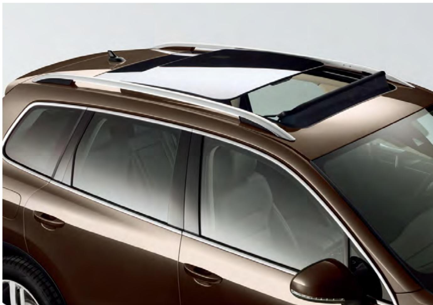
两片式全景天窗，前玻璃板可移动或上翘，带电动遮阳帘，令车内始终保证良好的采光，愈显通透，营造豪华舒适的驾乘氛围。同时具备防夹功能，还可通过钥匙遥控直接开关，将安全性与便捷性完美融汇。
