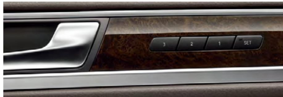
记忆包可存储驾驶座椅及电动外后视镜的位置。倒车时副驾驶侧的外后视镜自动降低, 让倒车更加轻松从容。
