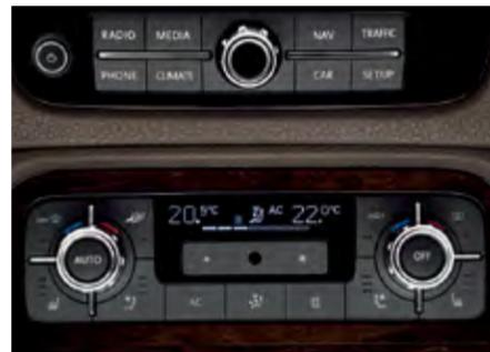
2区“Climatronic”恒温空调, 可对前排乘坐区域进行分开独立调节, 更能依据太阳光的强度以及外部温度的高低, 自行输出适宜温度, 当倒车或启动雨刮时会关闭自动空气循环开关, 从而防止异味或者尾气进入车内。
