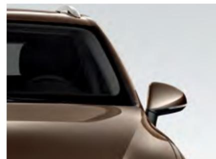
电动外后视镜可进行电动调节翻转，并具备独立加热功能。为了您能拥有更佳的视野，驾驶员一侧的后视镜呈球面，方便您时刻洞悉后方驾驶情况。
