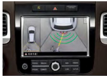
全景摄像模式“Area View”还能让您将车辆周围地面状况尽览眼底，杜绝狭窄路况剐蹭的发生，越野时防止车辆托底。
