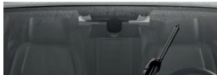
雨天行驶时，隐藏于内后视镜支架上的雨量传感器可自动激活，并根据雨量大小调节雨刮的运动频率，时刻确保清晰视野。
