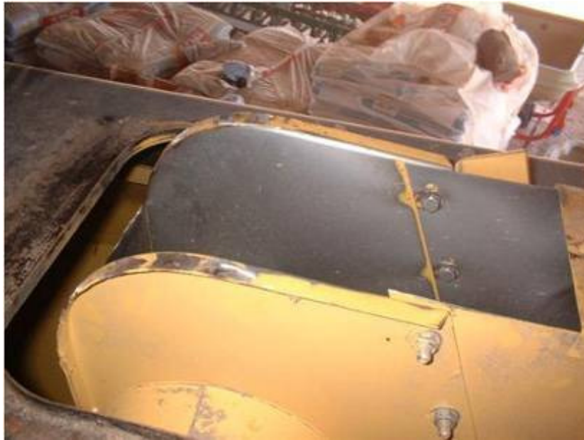
Figura 38 - Abertura no topo do elevador de grão para montagem do sensor de massa
