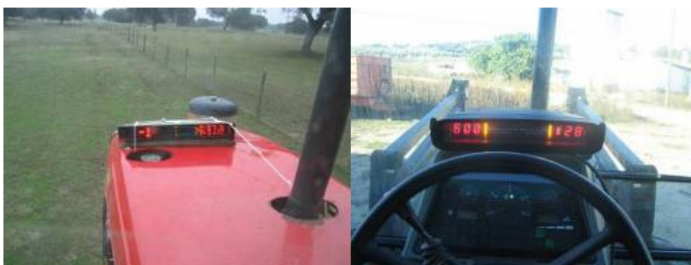
Figura 70 – Sistema “lightbar” de apoio à condução em linha recta do conjunto tractor-distribuidor
