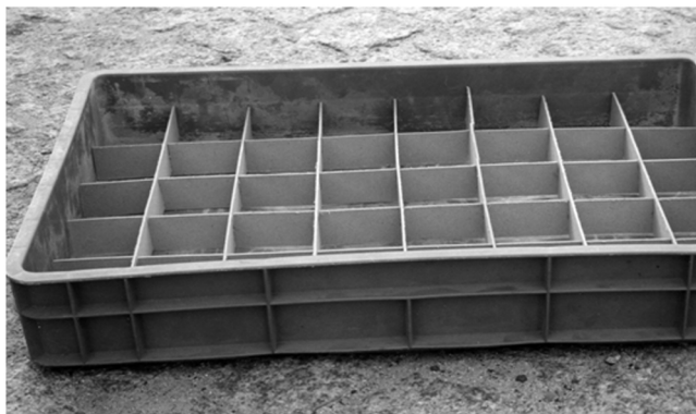
Figura 66 – Recipientes de recolha do adubo no campo; pormenor do dispositivo “anti-salpico”
