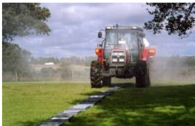
Figura 65 – Ensaio de distribuição longitudinal do adubo
