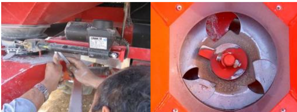
Figura 58 - À esquerda, actuador eléctrico; à direita, abertura das placas de dosagem do adubo
