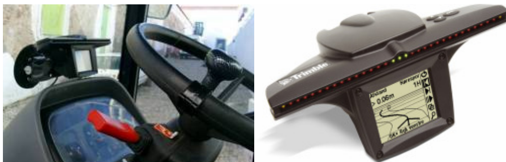
Figura 18 – Sistema de condução assistida por GPS em que todos os componentes estão concentrados num único módulo compacto que é acoplado ao vidro dianteiro da cabine por “vácuo” e em que apenas se liga o cabo da alimentação e da antena GPS
