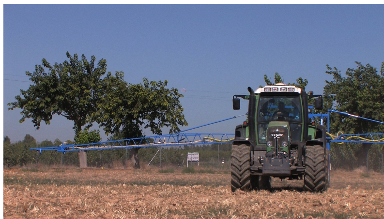
Figura 10 – Distribuidor de adubo pneumático com sistema VRT (Centro de Investigación Agraria Finca La Orden – Valdesequera)
