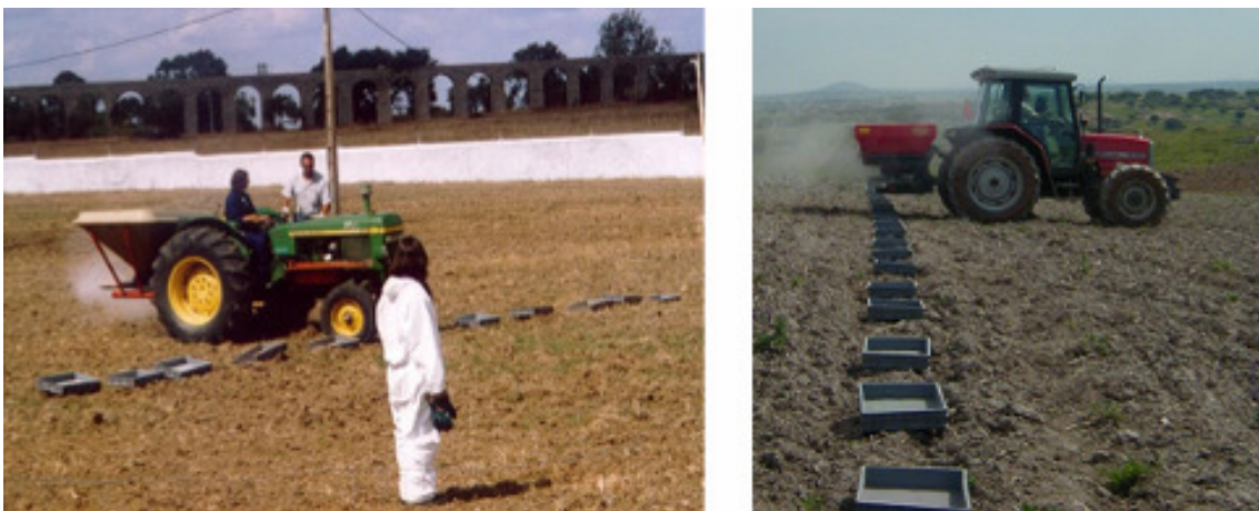
Figura 68 – Ensaios de campo para avaliação da largura efectiva de trabalho de distribuidores de adubo
