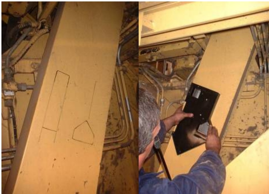
Figura 36 - Marcações e ajuste do sensor de humidade no elevador de grão
