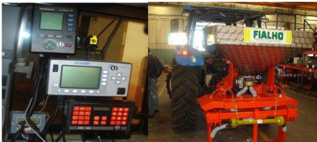
Figura 27 – Adaptação de um distribuidor convencional com possibilidade de funcionar em modo centrífugo ou enterrando o fertilizante em dois dentes. O kit de adaptação é constituído por um (1) motor hidráulico de variação da velocidade do cilindro canelado de distribuição, (2) um sensor de rotações de feedback, (3) leitor e interpretador do mapa de prescrição associado a GPS (Agleader) e (4) um controlador VRT
