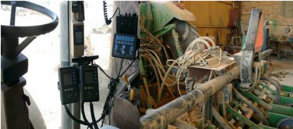
Figura 30 – Sistema de VRT de semente Dickey-John instalado num semeador John Deere de 6 linhas. À esquerda o controlador VRT instalado na cabine do tractor. À direita o variador de fluxo visto de trás
