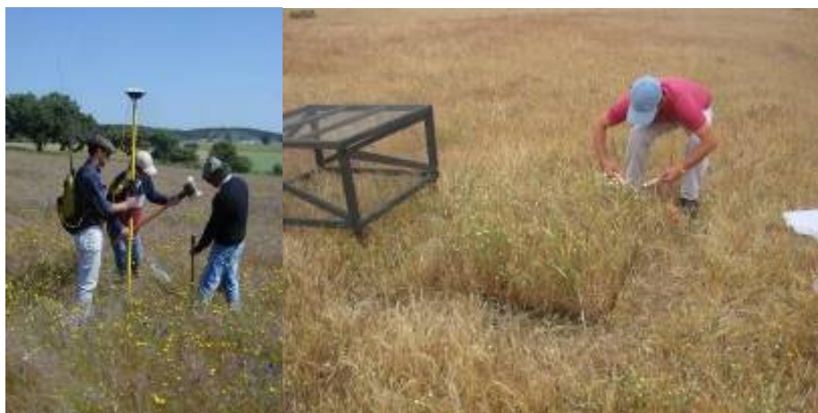
Figura 72 – Recolha de amostras georeferenciadas, de solo (à esquerda) e de pastagem (à direita)
