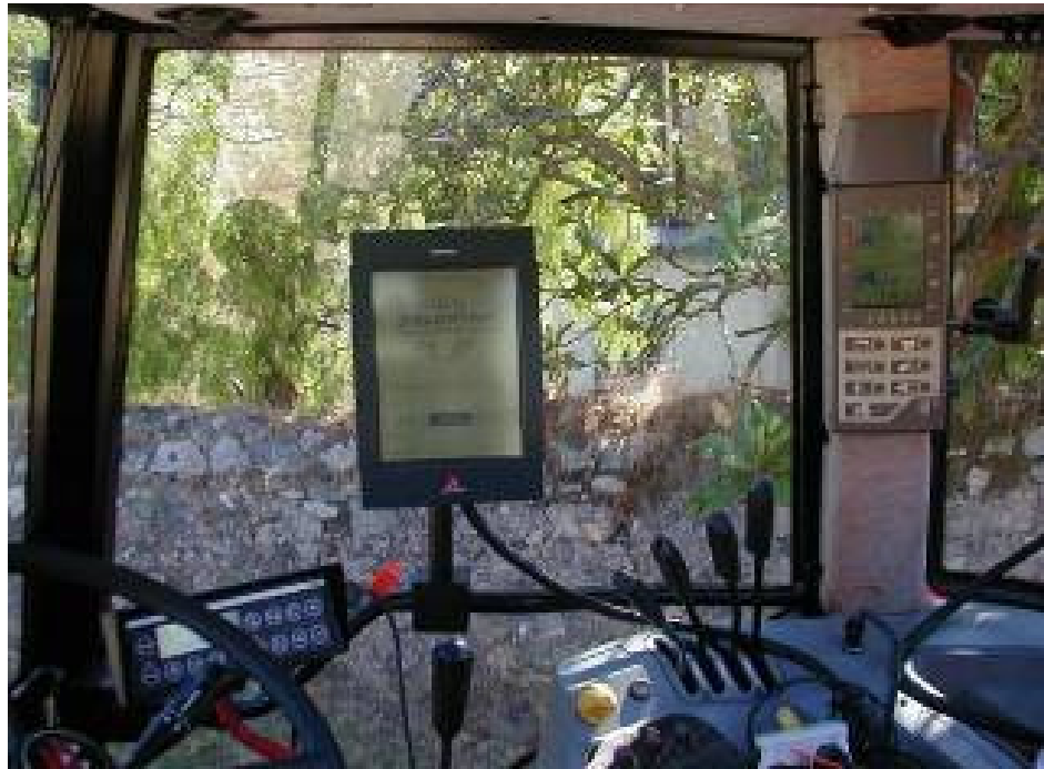
Figura 60 – Sistemas “Ferticontrol” (em baixo, à esquerda), “Fieldstar” (ao centro) e “Datatronic 2” (à direita), instalados na cabina do tractor MF 6130
