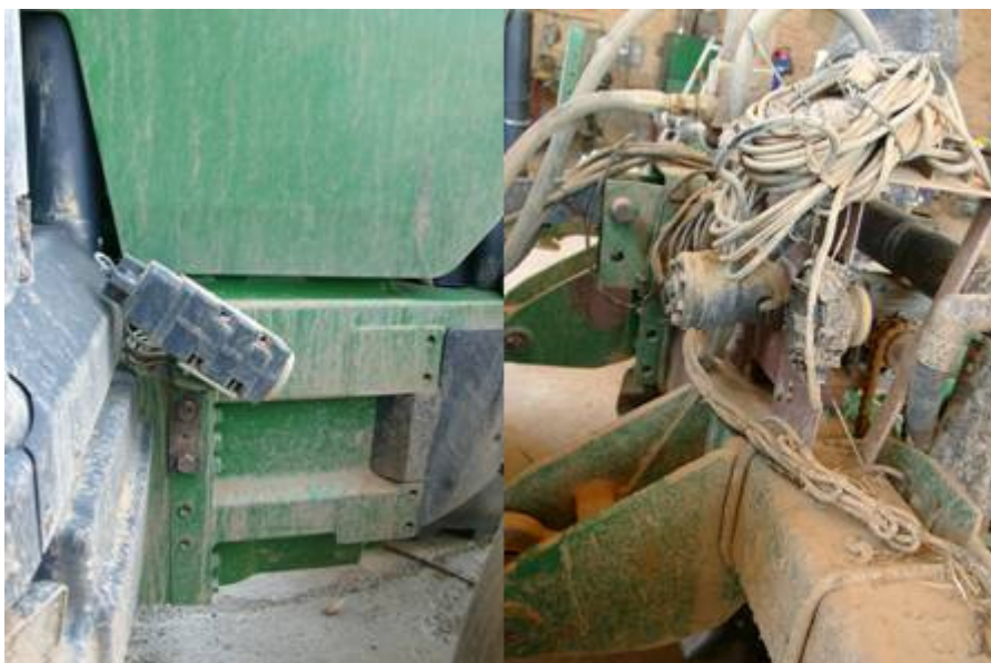
Figura 29 – Sistema de VRT de semente Dickey-John instalado num semeador John Deere de 6 linhas. À esquerda o sensor de velocidade real entre o motor a roda dianteira direita. À direita o variador de fluxo visto pela frente
