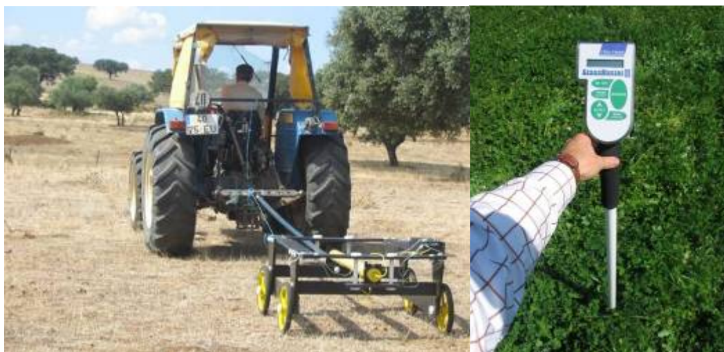
Figura 75 – Medidor de condutividade eléctrica do solo “DUALEM” (à esquerda) e medidor da massa de matéria seca da pastagem “Grassmaster II” (à direita)
