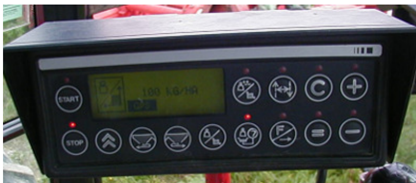
Figura 56 – “Ferticontrol” sistema de comando do distribuidor centrífugo de adubo "Vicon RS -EDW"
