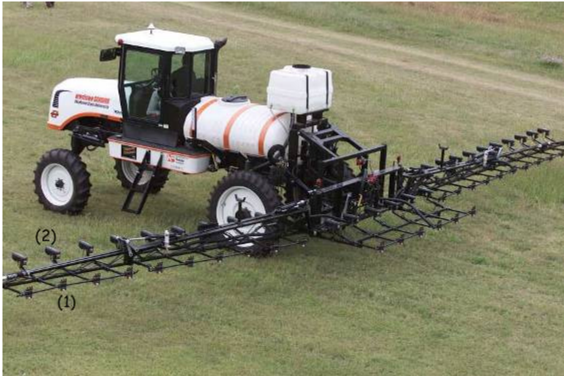
Figura 23 – Exemplo de Tecnologia de Taxa Variável (VRT) para azoto com base em sensores. A taxa de adubo aplicado em (1) é função do teor de clorofila medido em (2)
