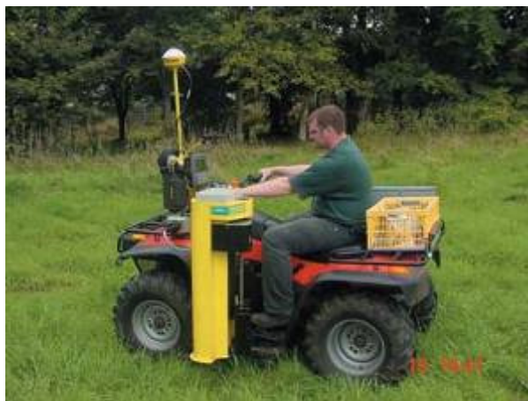
Figura 3 – Moto-quatro adaptada para recolha de amostras de solo geo-referenciadas
