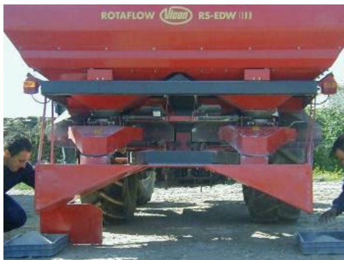
Figura 63 – Depósito de recolha de adubo simultânea de ambos os discos de um distribuidor centrífugo
