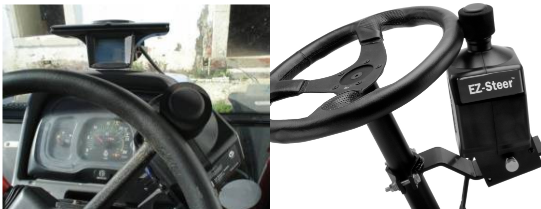
Figura 20 – Sistema de condução automática com actuação no volante por um motor eléctrico que através de uma roda de fricção faz a orientação do volante em função dos desvios indicados pela barra de luzes e sem qualquer intervenção do operador
