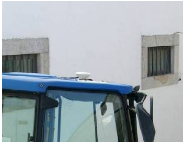
Figura 17 – Pormenor da montagem da antena GPS no topo exterior da cabine do tractor/máquina. Alternativamente pode ser montado directamente na alfaia ou outro ponto do tractor/máquina
