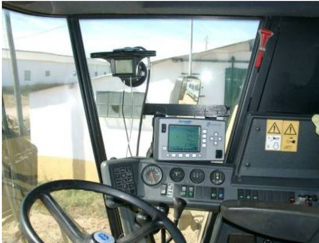
Figura 33 - Aspecto do interior da cabine da ceifeira com a consola instalado no campo de visão e acção do operador
