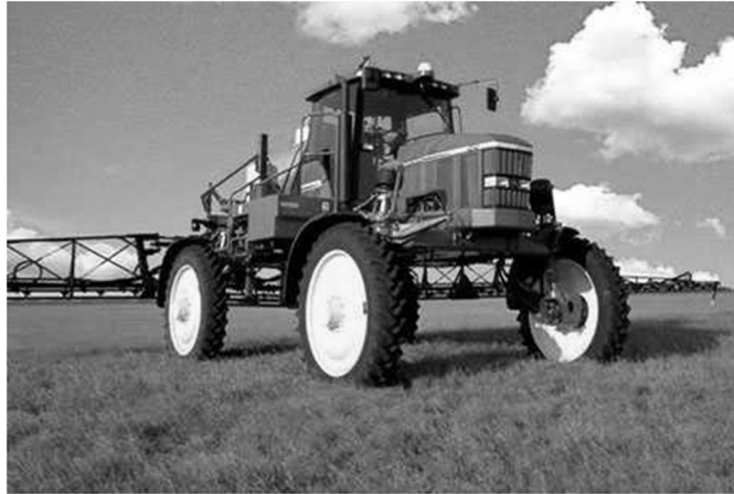
Figura 11 – Pulverizador VRT acoplado a tractor com antena de receptor GPS
