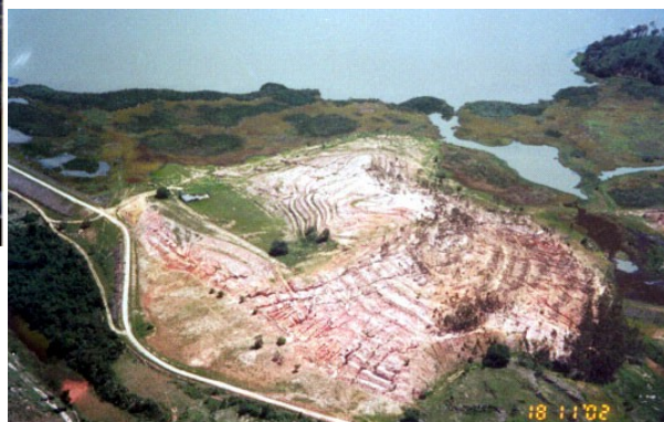
FOTOGRAFIA 13 – Detalhe de área degradada pela retirada de solo, na margem da Represa de Juturnaíba
