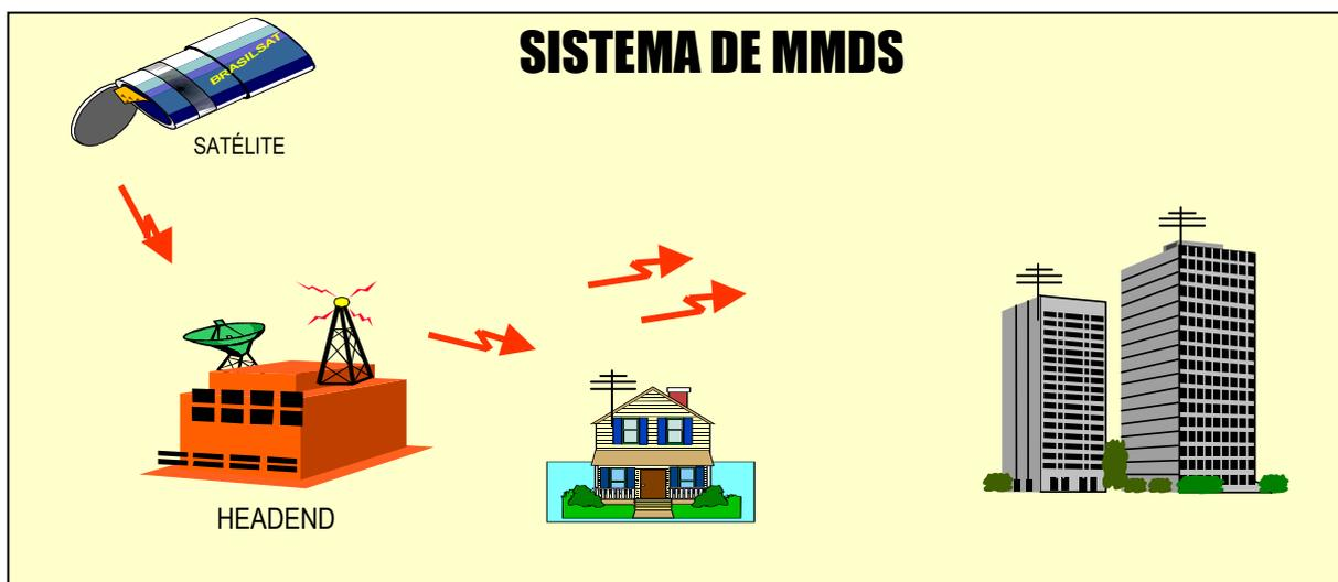
**MMDS**- A PROGRAMADORA TRANSMITE O SINAL POR SATÉLITE ATÉ O "HEADEND" DA OPERADORA, QUE ENVIA A PROGRAMAÇÃO AO ASSINANTE. ESTE A RECEBE ATRAVÉS DE UMA ANTENA DE MICROONDAS.
