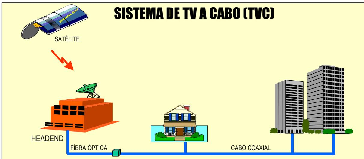
**CABO**- A PROGRAMADORA TRANSMITE O SINAL POR SATÉLITE ATÉ O "HEADEND" DA OPERADORA, QUE ENVIA A PROGRAMAÇÃO AO ASSINANTE POR MEIO DE CABO COAXIAL OU DE FIBRA ÓPTICA.
