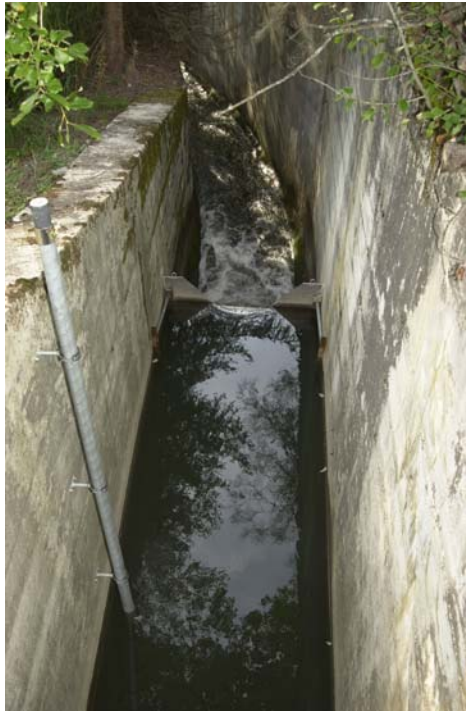
Photo 7. Station de mesure installée sur le trop-plein du lac d'Icogne (déversoir triangulaire)
