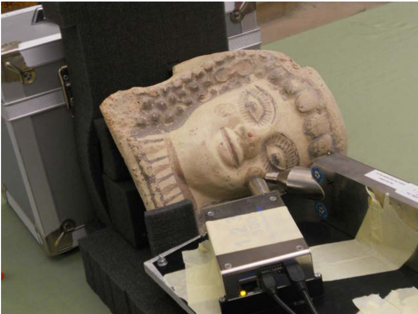
Fig. 1. Antefissa configurata a testa femminile da Morgantina sottoposta ad analisi di fluorescenza a raggi X.
