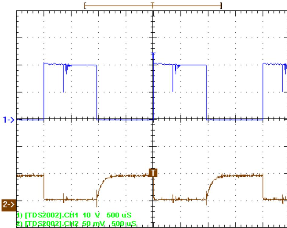
Skalierung: CH1 10 V / Div; CH2 50 mV / Div ; 500  $\mu$ S**Induktive Last, mit Freilaufdiode:**(Strom  $I_d$ )
