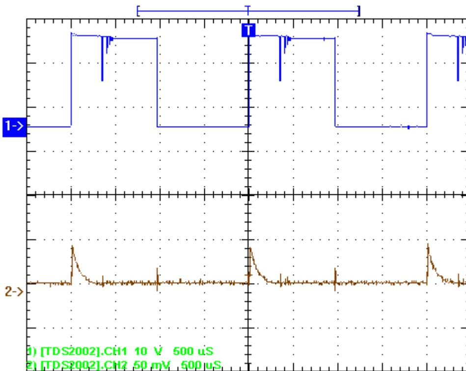
Skalierung: CH1 10 V / Div; CH2 50 mV / Div ; 500  $\mu$ S
