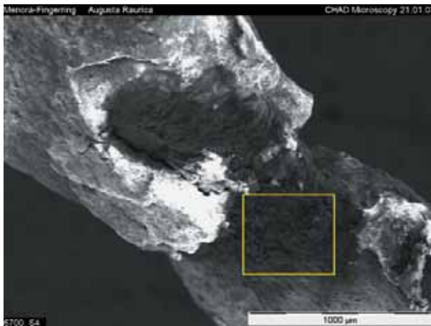
Taf. 7,3: Kaiseraugst AG. Der Menora-Ring. Bruchstelle mit Bezeichnung der analysierten Fläche von ca. 500 µm × 500 µm.
