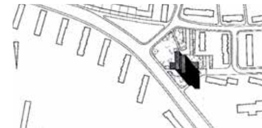
Lageplan, Dieter Oesterlen, 1960. Das 16-geschossige Hochhaus bildet den optischen Endpunkt der Saarstraße. Der Standort ist so gewählt, dass sich eine möglichst geringe Beschattung der umliegenden 3- bis 4-geschossigen Zeilenbauten ergibt.
