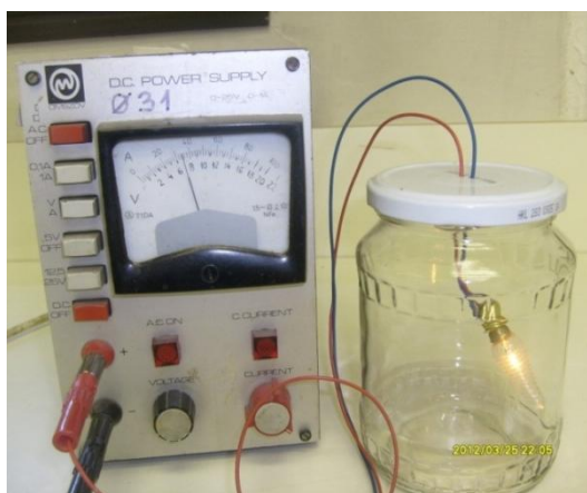
46. ábra A kísérleti berendezés az oxigénmentes térben való izzításhoz
