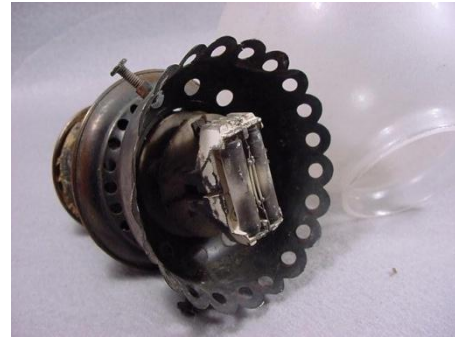
4. ábra Egy szétszerelt Nernst-égő. A nagyobb rudak a bemelegítésért felelnek, a kisebbek a világításért.
