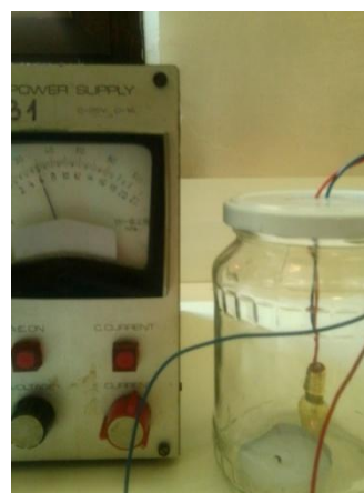
49. ábra Igen gyengén világító karácsonyfaizzó, mely pár másodperccel később kiégett a CO 2 -ot és vizet is tartalmazó gáztérben
