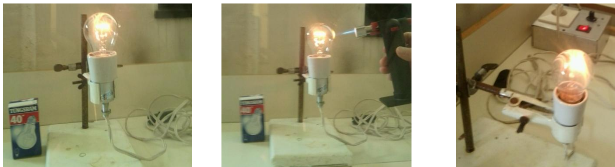
44. ábra A kísérlet képei a) a bekapcsolt izzó, b) az izzó kilyukasztása, c) a burára lecsapódó volfrám-oxid fehéres, halványsárga színűre színezi az üvegburát
