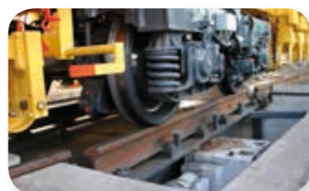
Messung des Ausdrehmoments der Drehgestelle
