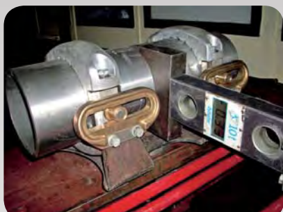
MEHANIČKA ISPITIVANJA NOSAČA AL CEVI Ø200 MM – T.F. ČAČAK – BOČNO OPTEREĆENJE
