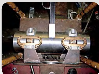
MEHANIČKA ISPITIVANJA NOSAČA AL CEVI Ø200 MM – T.F. ČAČAK – VERTIKALNO OPTEREĆENJE
