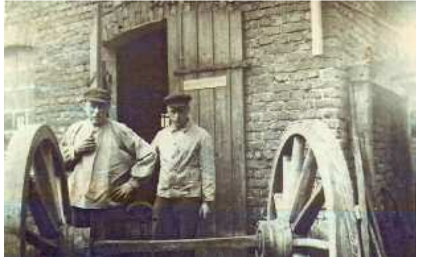
Die beiden Huf- und Wagenschmiedemeister Heinrich und Georg Jürgens vor der Werkstatt, hinter einem Wagenteil (Hinterachse mit Holzrädern, auf die Eisenreifen aufgezogen worden sind)
