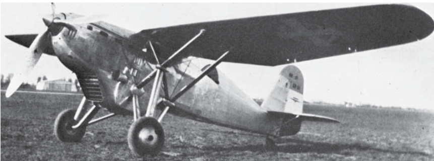
Ikarus IK-L1 sa uklonjenim aerodinamičkim oblogama stajnog trapa, april 1935, aerodrom Zemun Yugoslav aviation museum
