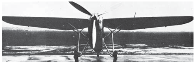
Ikarus IK-02, pogled s preda, prikazuje komplikovanu strukturu stajnog trapa i upornica krila. Slika nastala tokom testiranja, oktobra 1936. na aerodromu Zemun. Foto- Dobnikar collection
