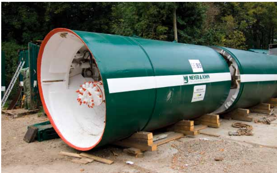
Vortriebsmaschine vor dem Einsatz
