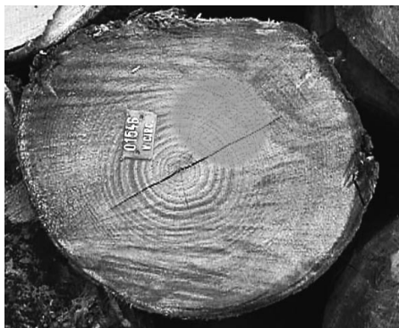
Figura 6: Esempio di cretto della fortuna. Si tratta di una fenditura radiale che si sviluppa nella zona centrale del fusto subito dopo l'abbattimento. Questo cretto viene chiamato «della fortuna» in quanto la sua presenza sta ad indicare che la coesione radiale del legno è sufficientemente buona per contrapporsi alla formazione di cipollature.
