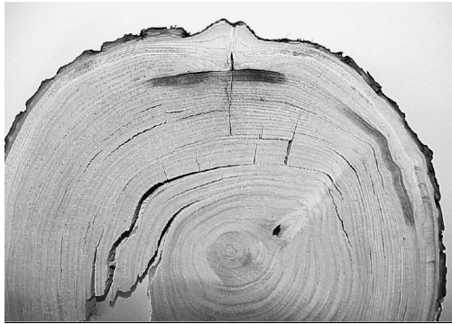
Figura 1: Esempio di rotella fortemente cipollata. Figure 1: Example of a stem with heavy ring shake.
