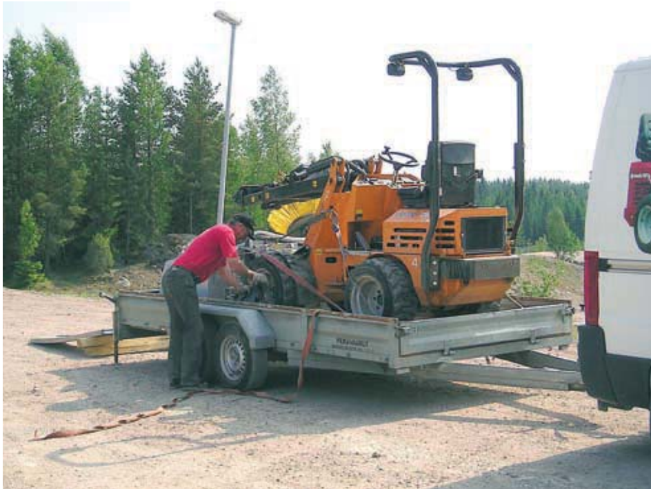
Kuormauksen ja kuljetuksen aikana tulee kuormain ja työvälineet lukita niin, että ne eivät pääse liikkumaan vahingossa. Kuva: Markku Lätti
