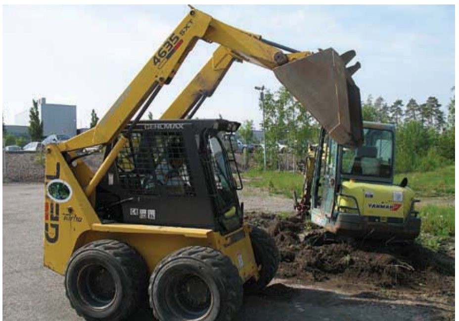
Varmista aina työkonteen lukitus, silloinkin, kun käytät työkonetta vain hetken. Lukitsematon työ-kone voi irrota ja pudota ohjaamoon tai lähellä olijan päälle. Lisäksi toinen koneen käyttäjä ei välttämättä tiedä lukitsemattomasta työkonesta, jolloin vaara on ilmeinen. Älä myöskään käytä toisen valmistajan työkonetta, jos niitä ei saa lukittua täydellisesti. Kuva: Markku Lätti
