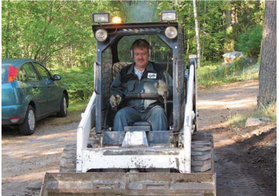
Turvapuomi (mahdollisesti myös turvavyö ja/tai istuintunnistin) keskuslukitusjärjestelmään kytkettynä estää koneen käytön ilman sen käyttöä, jolloin muun muassa puristuksiin jääminen puomin ja rungon väliin on lähes mahdotonta (jos ei kytkettynä tai jos istuimella ei istuta, niin kuormaimen ajo- ja/tai työhydrauliikka lukkiutuvat, kuormain ei käynnisty). Kuva: Markku Lätti
