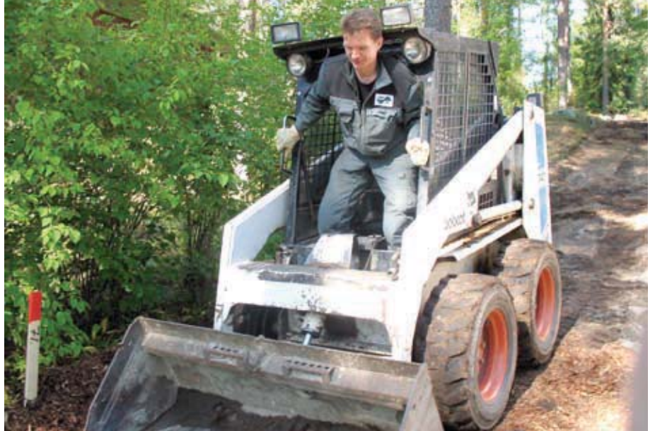
Nouse ohjaamoon ja poistu ohjaamosta kohtisuoraan kengät puhdistettuina käyttäen apuna tartuntarautoja ja mahdollista ovenkahvaa (kolmipisteote). Kuva: Markku Lähti
