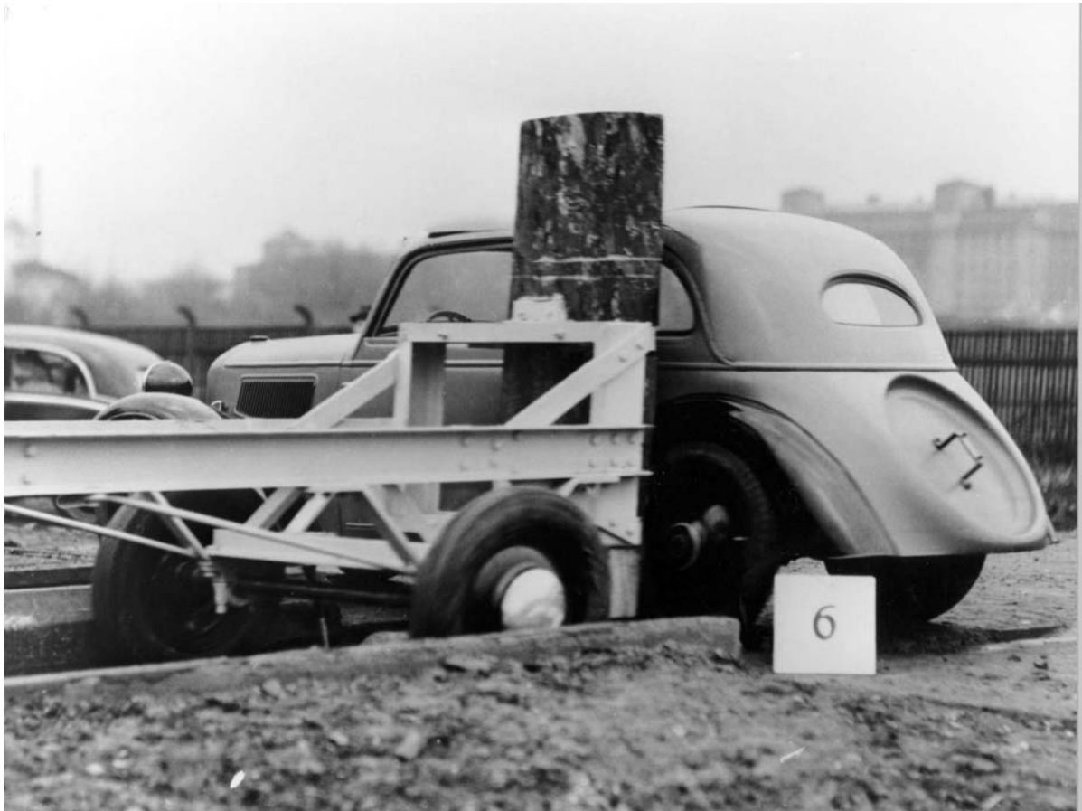
Abbildung 2: Katapultversuch DKW F7 mit Kunststoffkarosserie
