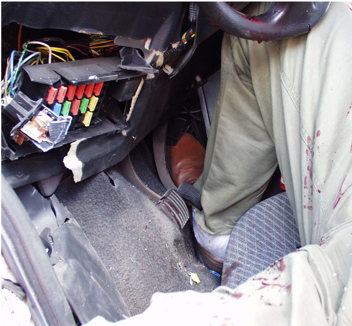
Abbildung 11: Typische Fußeklemmung durch Intrusion des Bodenblechs/Spritzwand einerseits und Pedalerie andererseits (Polytrauma mit Tod am Unfallort)
