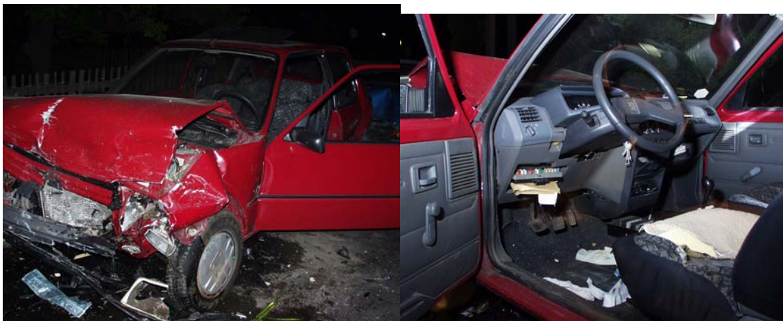
Abbildung 10: Fraktur des 4. und des 5. Mittelfußknochens rechts, zugezogen von einem Fahrer in einem Kleinwagen (Peugeot 205) am 23.05.2001 bei Frontalzusammenstoß mit BMW 3er. Die Geschwindigkeitsänderung \Delta v beträgt 33 km/h, der EES-Wert 25 km/h. Eine Fußraumintrusion liegt nicht vor.
