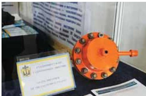
Статический суфлер газотурбинных двигателей
