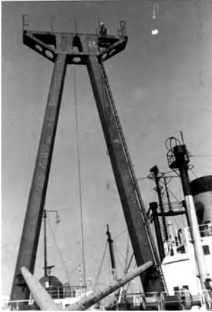
Η τοποθέτηση του δυποδικού ιστού.
