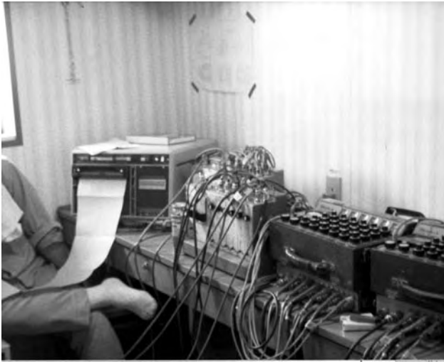
Τα όργανα μετρήσεως των κραδασμών και παραμορφώσεων του σκάφους.
