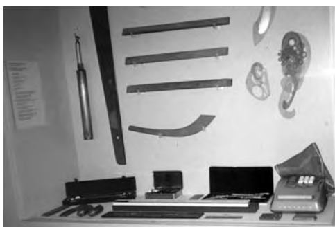
Όργανα σχεδιάσεως και υπολογισμών: γραμμοσύρτες, σιλική μελάνη, πενάκια, χάρακες, καμπυλόγραμμα, υποδεκάμετρα σε μετρικό και αγγλικό σύστημα, λογαριθμικός χάρακας, μηχανική αριθμομηχανή κλπ. Τα ανωτέρω, δωρεάς του Κ.Φ., ευρίσκονται στο Βιομηχανικό Μουσείο Ερμουπόλεως.
