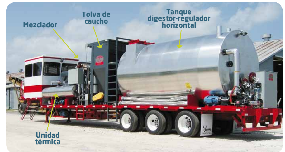
Figura 16. Unidad de fabricación con mezclador y tanque digestor
