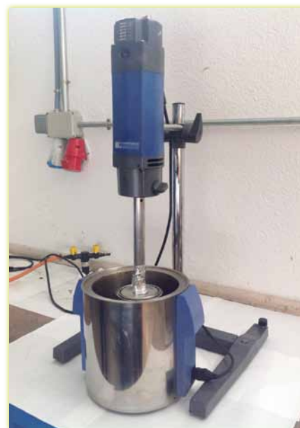
Figura 10. Disposición de un equipo básico de laboratorio para la fabricación de betunes con caucho
