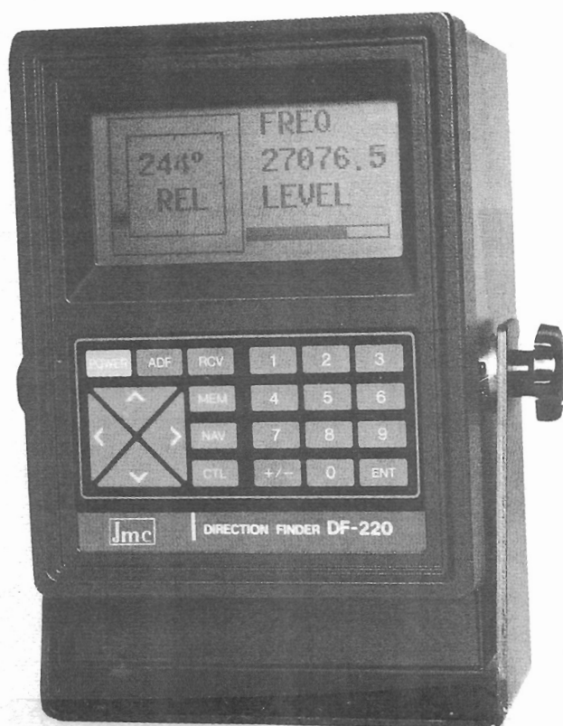
Σχήμα Β 2.11 : Αυτόματο ραδιογωνιόμετρο με ενσωματωμένο μικροϋπολογιστή για επίλυση ναυτιλιακών προβλημάτων
