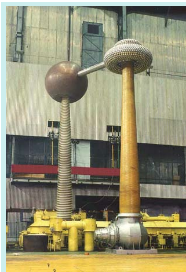
Рис. 8. Испытательная установка ВГИ на класс напряжения 1150 кВ
