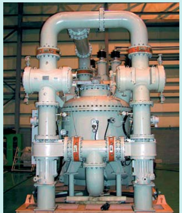
Рис. 6. Однофазный трехобмоточный трансформатор с изоляцией «NOMEX-SF 6 » мощностью 20 МВА с РПН для электрических сетей 154 кВ
