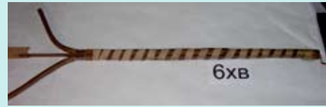
Рис. 3. Модель изоляции края холостого витка
