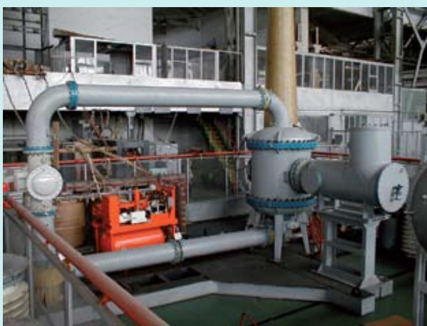
Рис. 4. Установка для высоковольтных и тепловых исследований конструкций в среде SF_6
