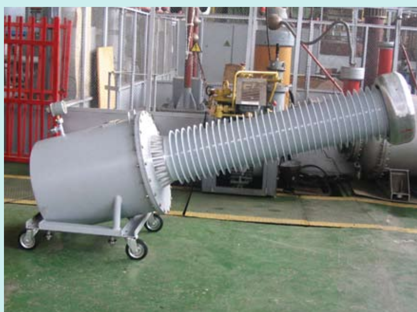
Рис. 5. Трансформатор напряжения ТНООГ-220-I
