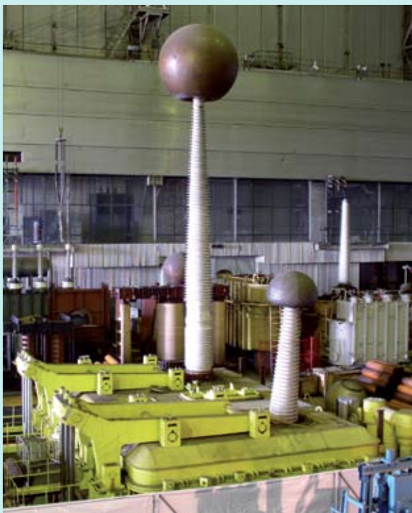
Рис. 3. Полномасштабная модель автотрансформатора класса напряжения 1800 кВ
