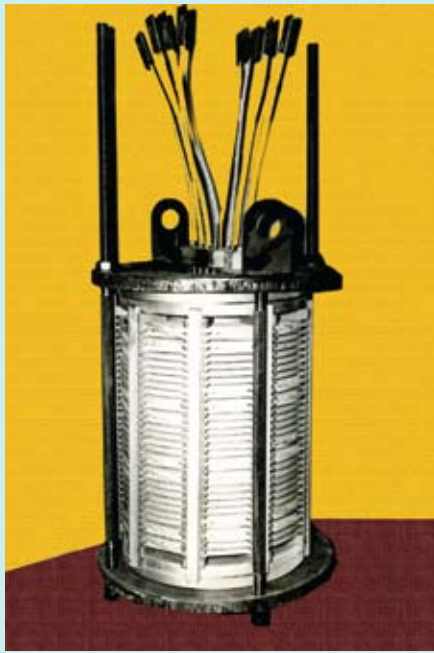
Рис. 1. Общий вид модели обмотки для ресурсных испытаний
