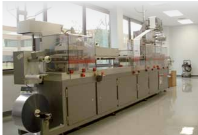
Bliesterproduktionsanlage beim Kunden
