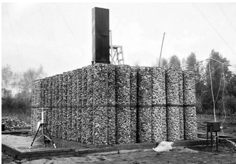
Конденсор атмосферной влаги лаборатории возобновляемых источников энергии в г.Обнинск
