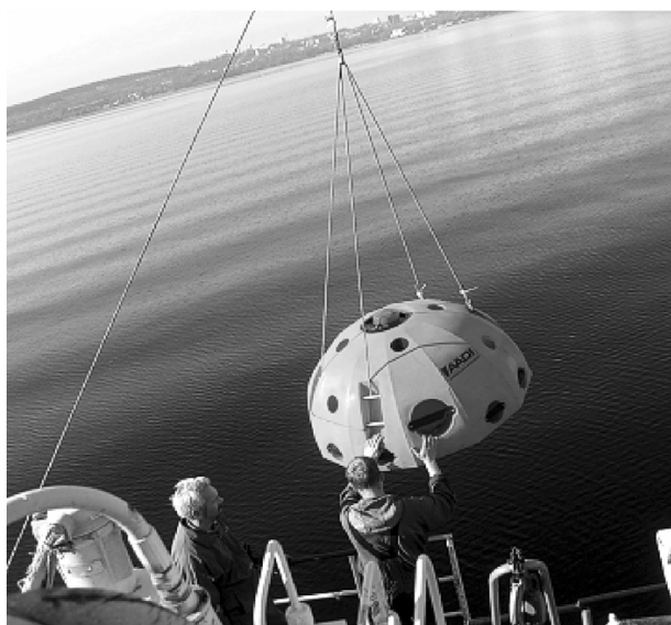
Погружение доплеровского профилографа скорости течения RDCP-600 (сентябрь 2007)
